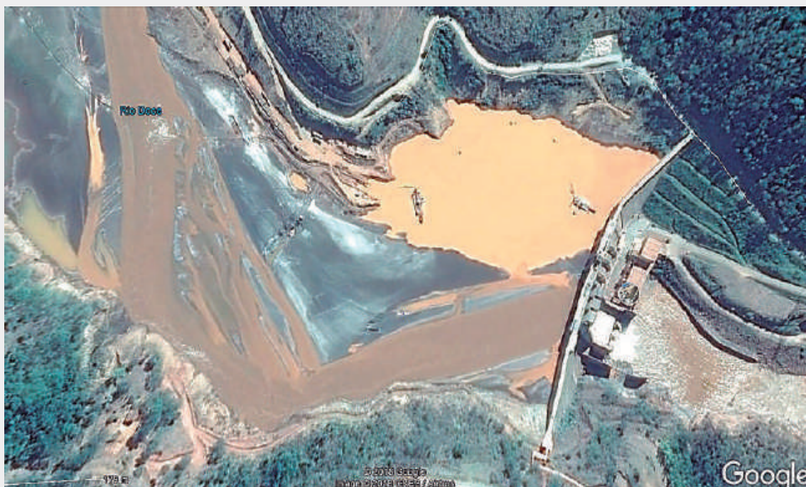
Figura 1.47 – Imagem da barragem da UHE Risoleta Neves (antiga Candonga) mostrando os depósitos de lama acumulados em curto espaço de tempo após o rompimento da barragem do Fundão (MG) (Google Earth, de 01/08/2016)
