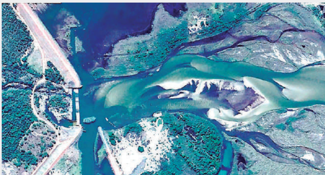
Figura 1.46 – Assoreamento no reservatório da UHE Itiquira I (Google Earth, de 22/07/2017)
