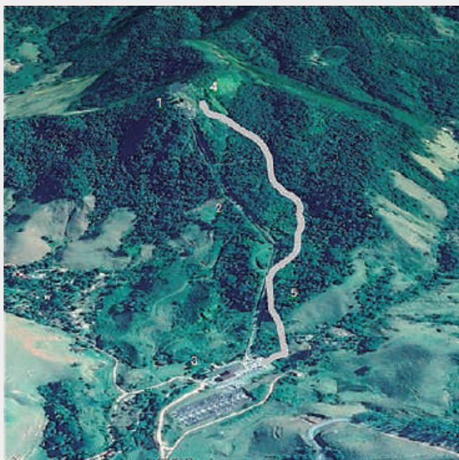
Figura 1.36 – Central Hidrelétrica Macabu: 1) chaminé de equilíbrio; 2) condutos forçados; 3) casa de força; 4) local da ruptura do túnel de adução; 5) trajetória aproximada da corrida de detritos (Google Earth, de 02/08/2017, modificada)
