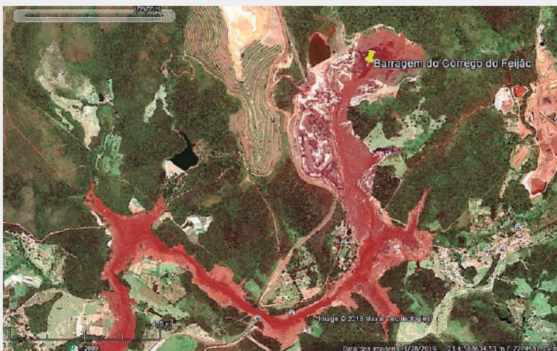
Figura 1.58 – Área da barragem do Córrego do Feijão e a faixa de terreno impactada (Google Earth, de 28/01/2019)
