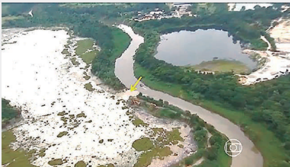
Figura 1.57 – Jacareí (SP): vazamento de água com sedimentos através da brecha aberta na “barragem” (assinalada pela seta) (Globo.com.g1)
