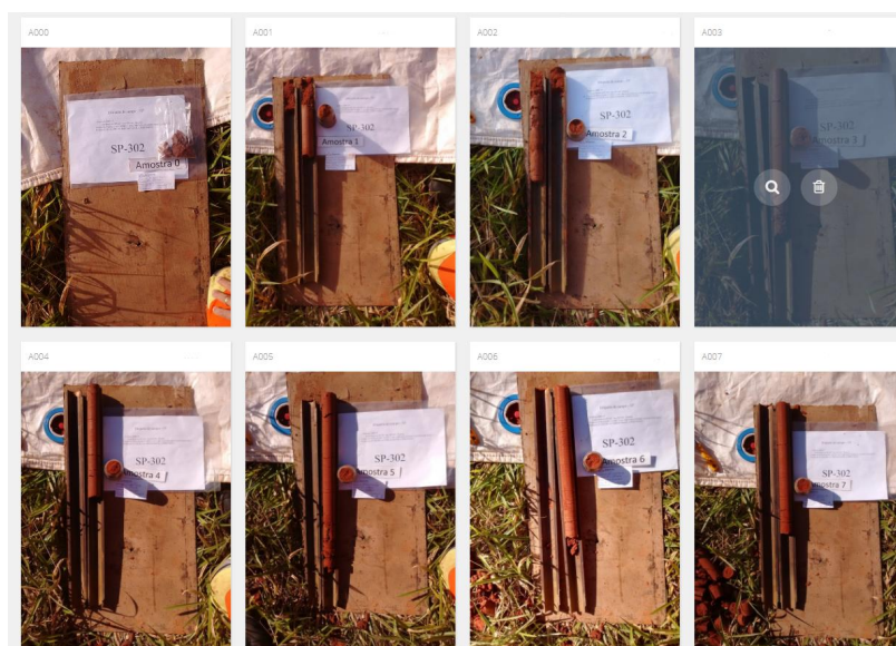
Figura 4. Ilustração do registro fotográfico das amostras e dos amostradores a cada metro ensaiado.
