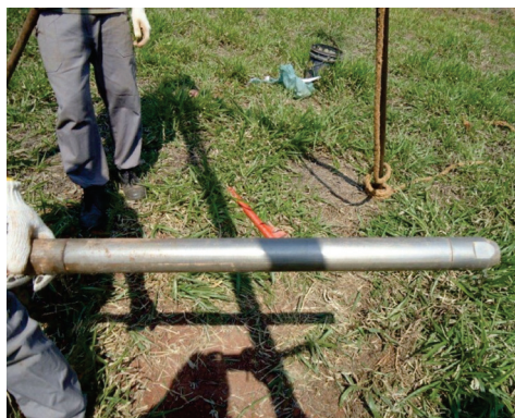
Sondagem a percussão: amostrador SPT pronto para descer no furo.
