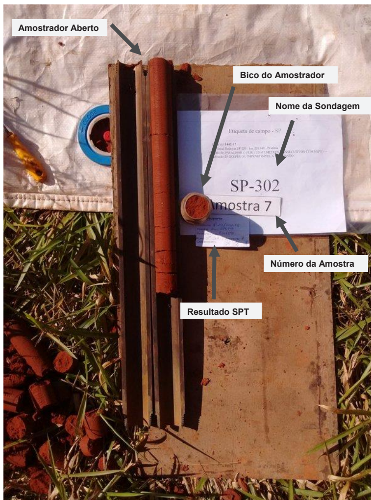
Figura 5. Foto que registra o amostrador aberto e as etiquetas com identificação sondagem, número da amostra (profundidade) e resultado do ensaio SPT.
