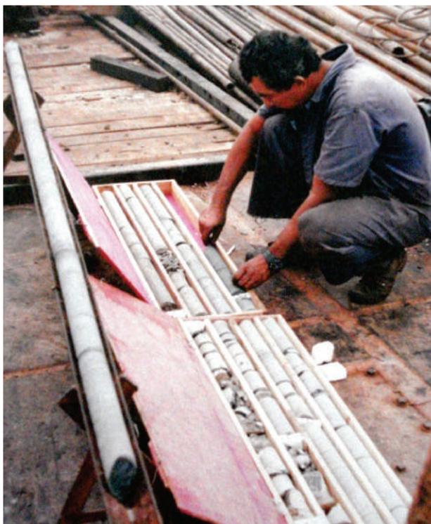
**Figura 33** – Acondicionamento de testemunho de sondagem.
