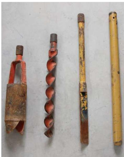
**Figura 27** – Equipamentos para sondagem a percussão.
