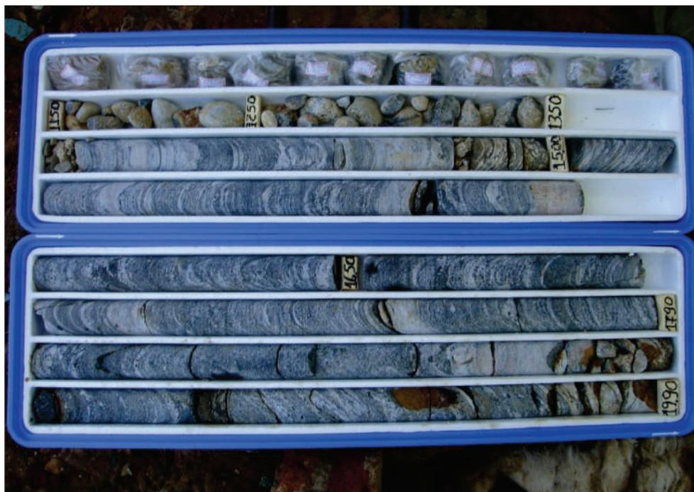
**Figura 30** – Caixa de amostra de sondagem mista.
