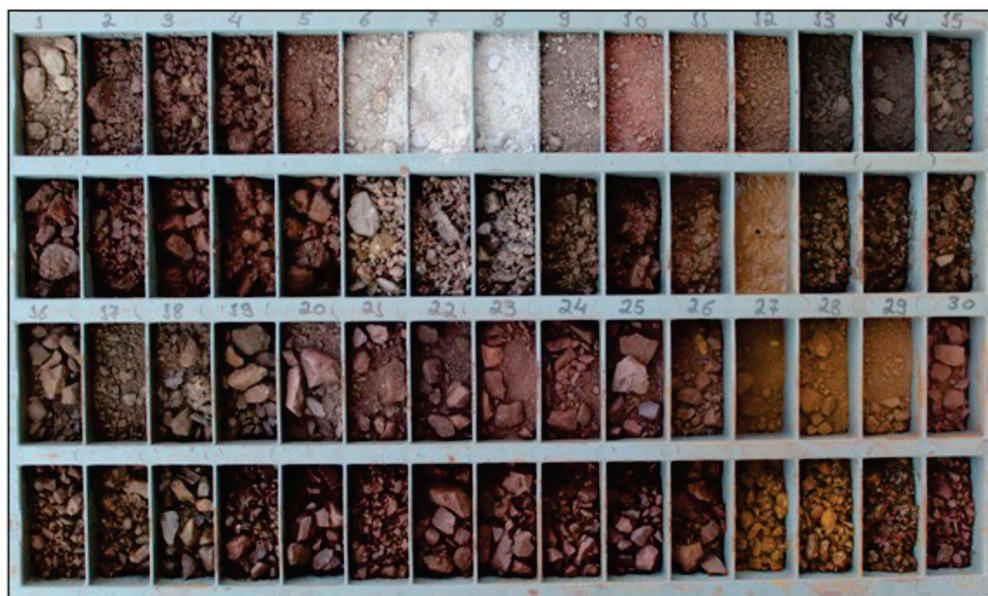
Figura 7 – Caixa de chips: As amostras são colocadas em duplicidade, sendo uma amostra a in situ e outra peneirada e lavada.
