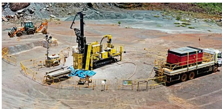
Figura 4 – Sonda RC e compressor embarcado em veículo auxiliar.
