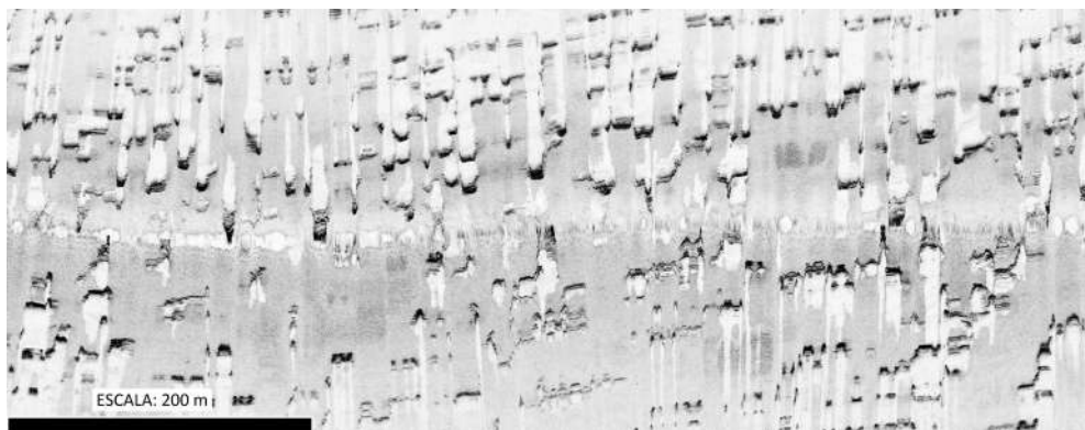
Figura 8 – Imagem do Sonar de Varredura Lateral (Edgetech 4100 – 500 kHz) mostrando recifes de corais na superfície de fundo da região de Abrolhos, litoral sul da Estado da Bahia.
