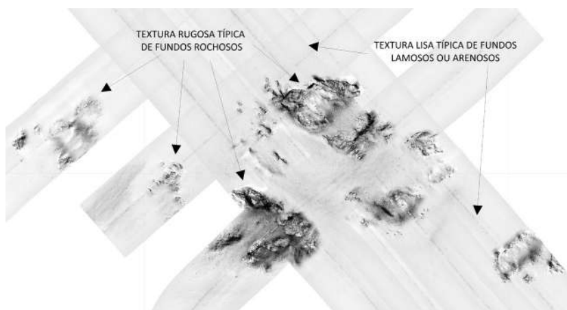
Figura 13 – Mosaico de imagens de Sonar de Varredura Lateral da costa leste dos EUA, mostrando contrastes texturais entre os diferentes tipos de fundo. Dados processados pelo software SonarWiz7.6.
