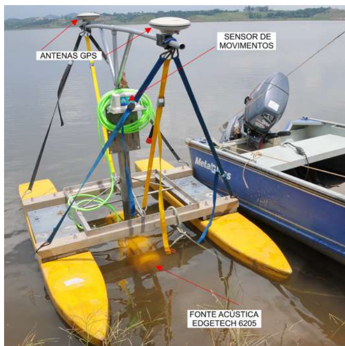
Anexo 2, Figura 6 – Sistema híbrido multifase (Batimetria 550 kHz + Sonar de Varredura Lateral 550/1.600 kHz) modelo Edgetech 6205, em levantamento experimental no lago Taiapuêba, Suzano, SP.
