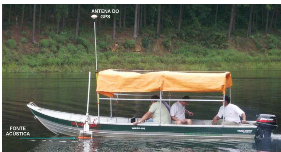
Anexo 1, Figura 5 – Embarcação de pequeno porte equipada com GPS (Global Positioning System) e ecobatímetro monofeixe de dupla frequência (Kongsberg-Simrad EA400 38 e 200 kHz), pertencente ao IPT e em operação no lago Cabuçu, Guarulhos, SP.
