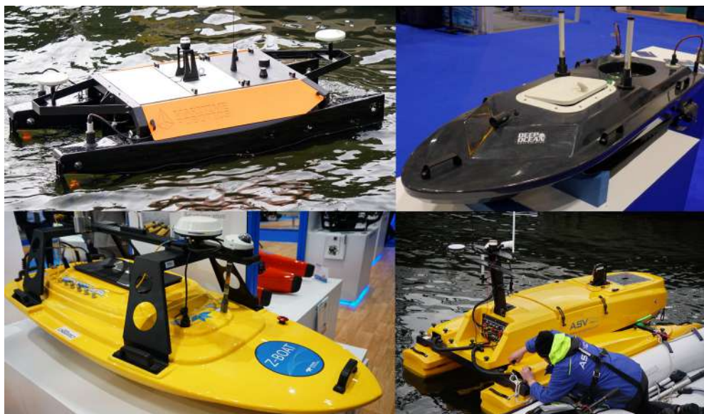
Figura 4 – Exemplos de veículos autônomos de superfície (ASV/USV) disponíveis no mercado, em levantamentos experimentais de demonstração durante a Feira Oceanology International (OI2018 Londres).
