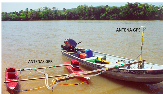
Figura 1 – Embarcação de pequeno porte adaptada pelo IPT para execução de levantamentos de GPR (Ramac) no rio Taquari, MT.
