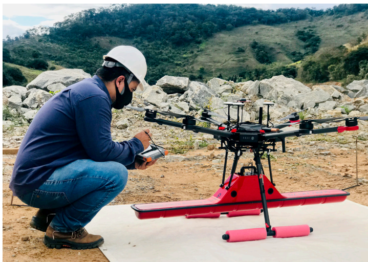
Figura 3 – Antena de GPR de 80 MHz instalada em um drone.
