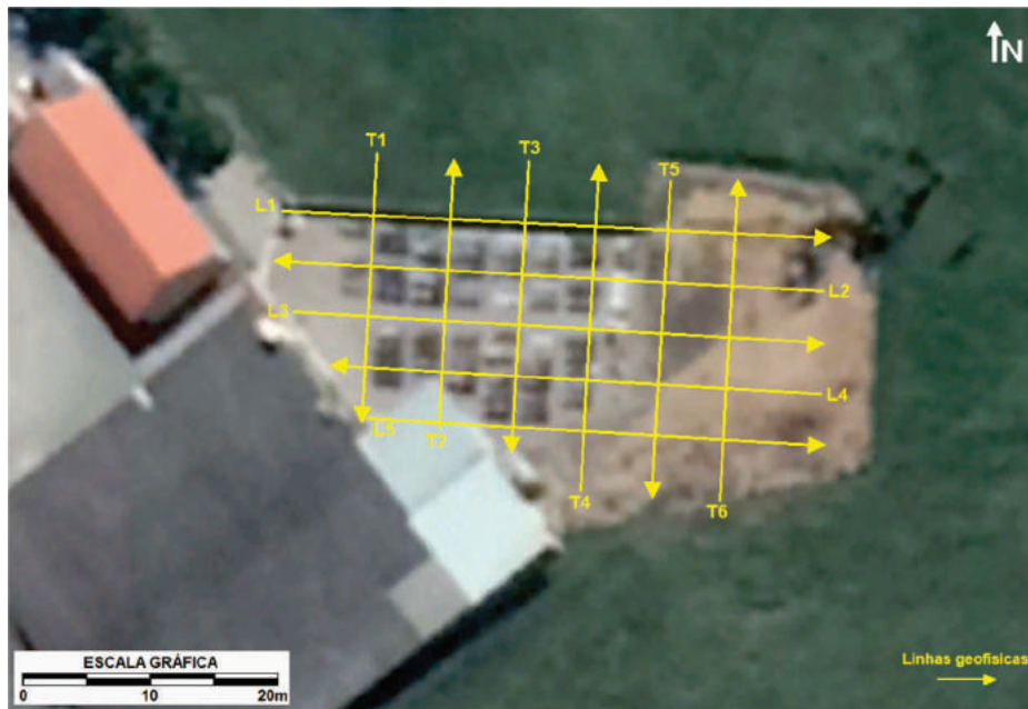
Figura 11a. Linhas de Resistividade Capacitiva executadas em cemitério.
