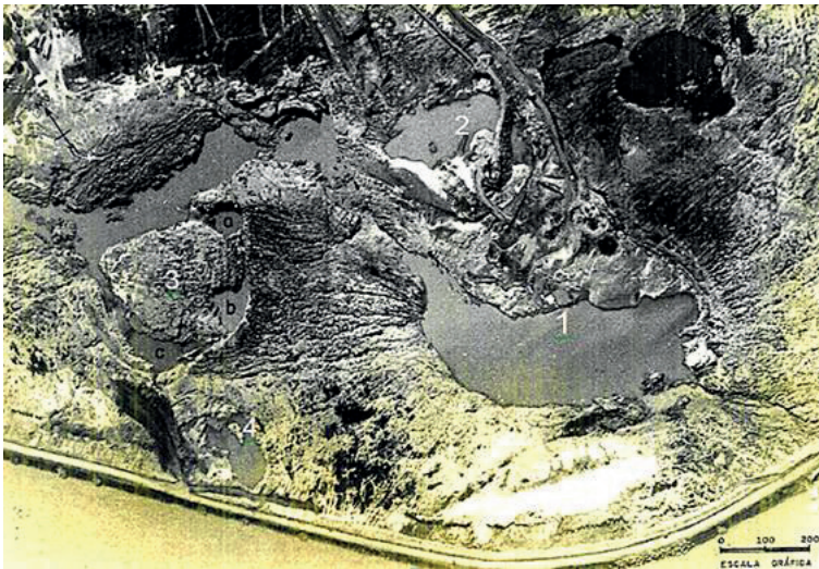
Figura 11.1.1.4 – Água Vermelha – Estruturas circulares de maior interferência com o projeto. As letras a, b e c indicam locais mais profundos (Araújo, 1982).
