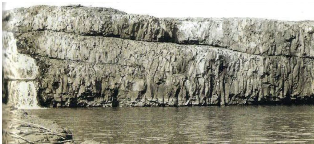
Figura 11.1.2.1 – Água Vermelha – Extensas juntas subhorizontais interceptam o maciço rochoso na Cachoeira dos Índios (ABGE, 2017, pág. 163).
