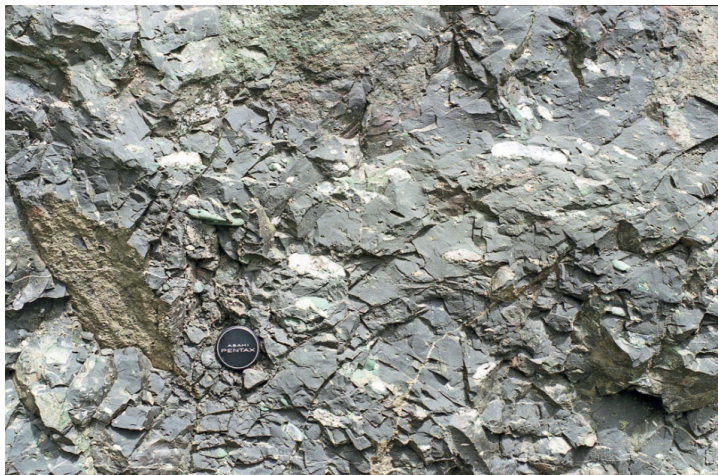
Figura 11.2.4 - Bariri - Leptoclastes ao longo da parede esquerda de escavação da eclusa.
