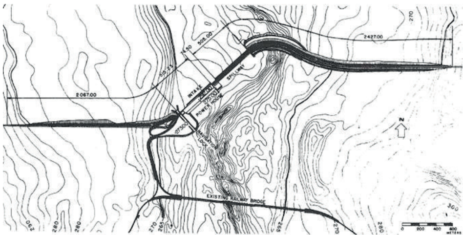
Figura 11.16.1.1 - Jupuí - Arranjo geral (ABGE/ABMS, 1983).
