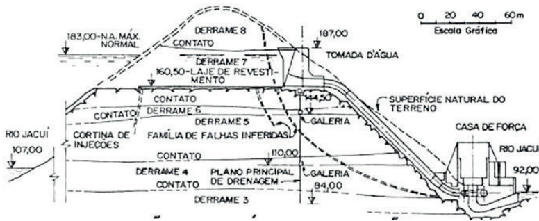
Figura 11.15.3 - Itaúba - Seção geológica esquemática, com indicação dos falhamentos (Guidicini & outros, 1981).
