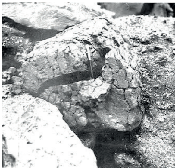
Figura 11.16.2.1 - Jupia - Blocos de basalto vesicular em início de desagregação (Ruiz, 1963).
