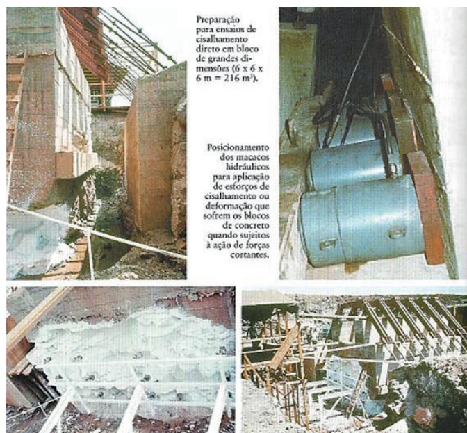
Figura 11.12.1.8 - Ilha Solteira - Ensaios de cisalhamento e deformabilidade em bloco de grandes dimensões (6 x 6 x 6 m) (Abge, 2017, pág. 52).
