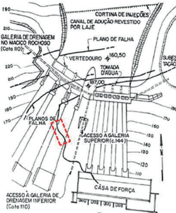
Figura 11.15.2 - Itaúba - Localização das falhas conchoidais em planta, na área das estruturas de concreto. O trecho de falha assinalado pode ser visualizado na Figura 11.15.3 (Guidicini & outros, 1981).
