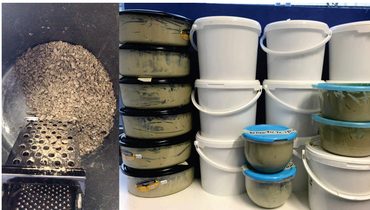
Figura 6. Preparação das amostras, à esquerda ralando rochas brandas argilosas e à esquerda, armazenando amostras em fase de obtenção da consistência. Esta é a etapa mais demorada da metodologia.
