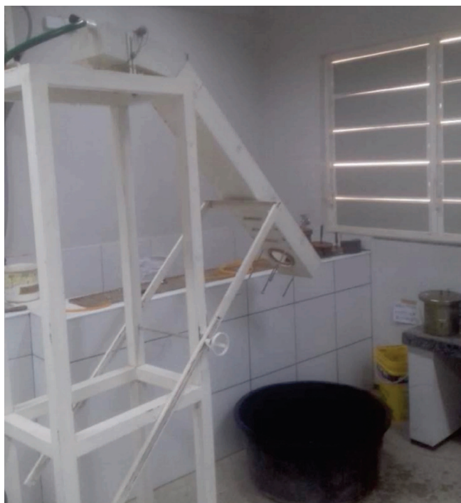
Figura 6. Vista do Equipamento de Inderbitzen (UFCA).
