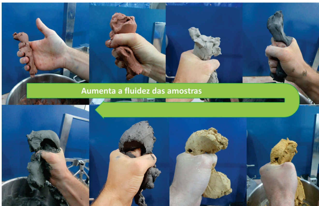
Figura 14. Vários exemplos do material testado sendo espremido após cada teste.
