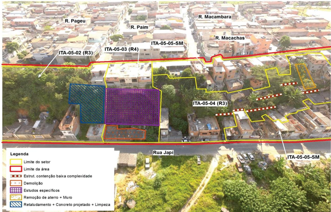
**Figura 2** - Exemplo de mapeamento de risco com a indicação de intervenções estruturais.
