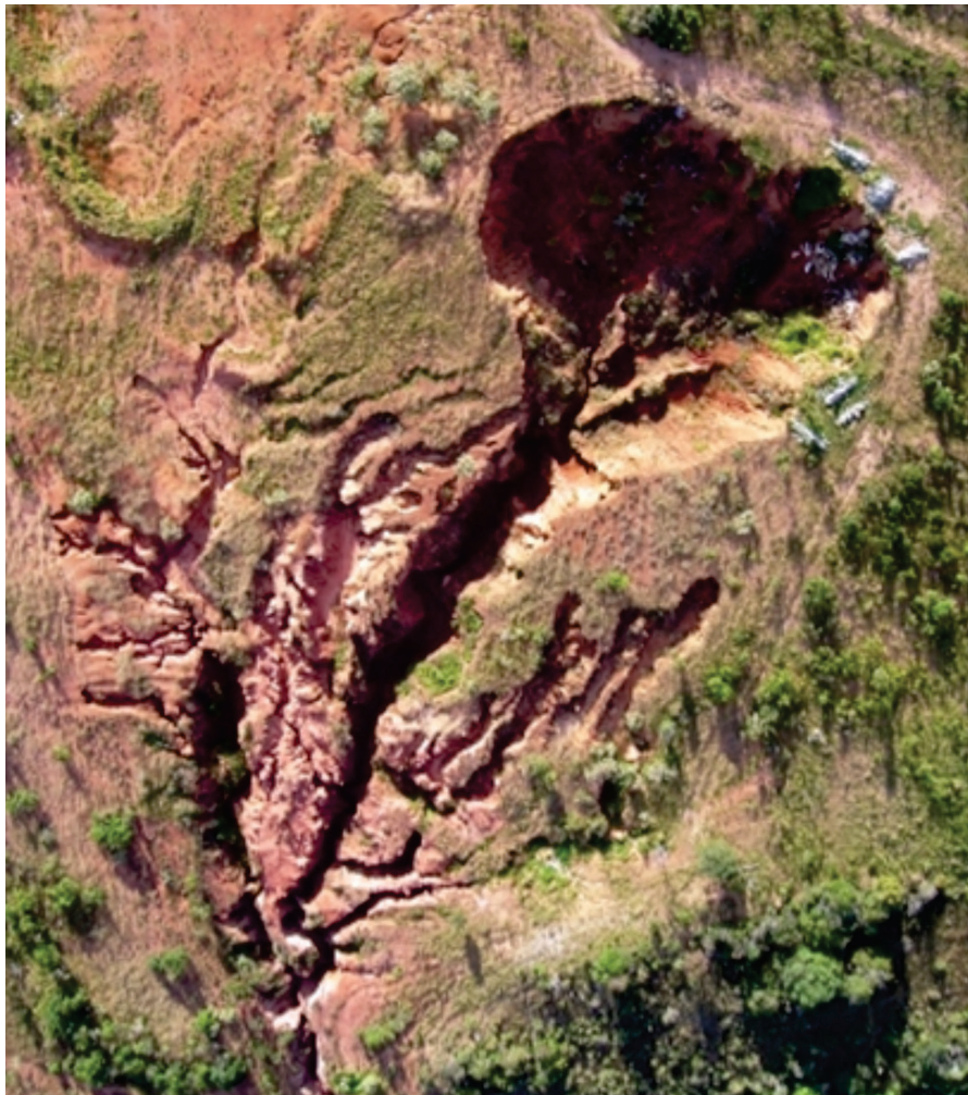
Figura 3. Bossoroca em evolução. Notar ravinamentos secundários que tendem a se transformar em novas bossorocas. Fonte: Foto Fazenda Glória, Uberlândia MG.
