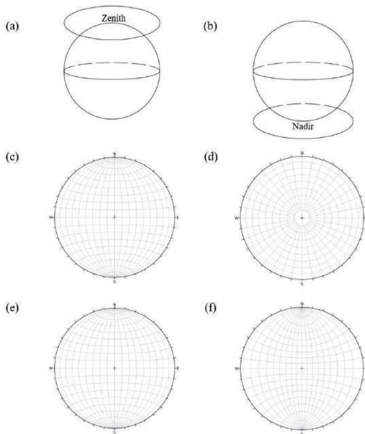
**Figura 4.** (a) hemisfério superior, (b) hemisfério inferior, (c) projeção equatorial, (d) projeção polar, (e) rede estereográfica de Schmidt, (f) rede estereográfica de Wulff (Fonte: Elaborado pelo autor 2023).
