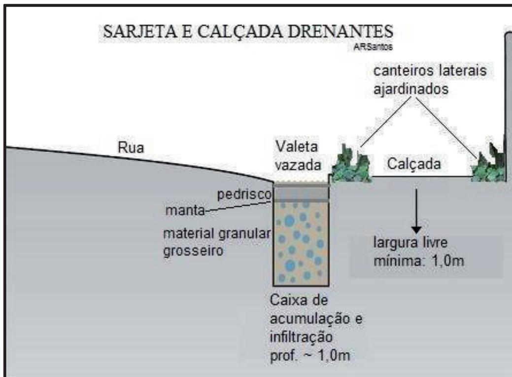
**Figura 14** - Croqui de combinação de valetas drenantes e calçadas com canteiros laterais. As águas de chuva obrigatoriamente passam pelas valetas urbanas, o que as qualifica como ótima oportunidade de acumulação e infiltração de um bom volume dessas águas.
