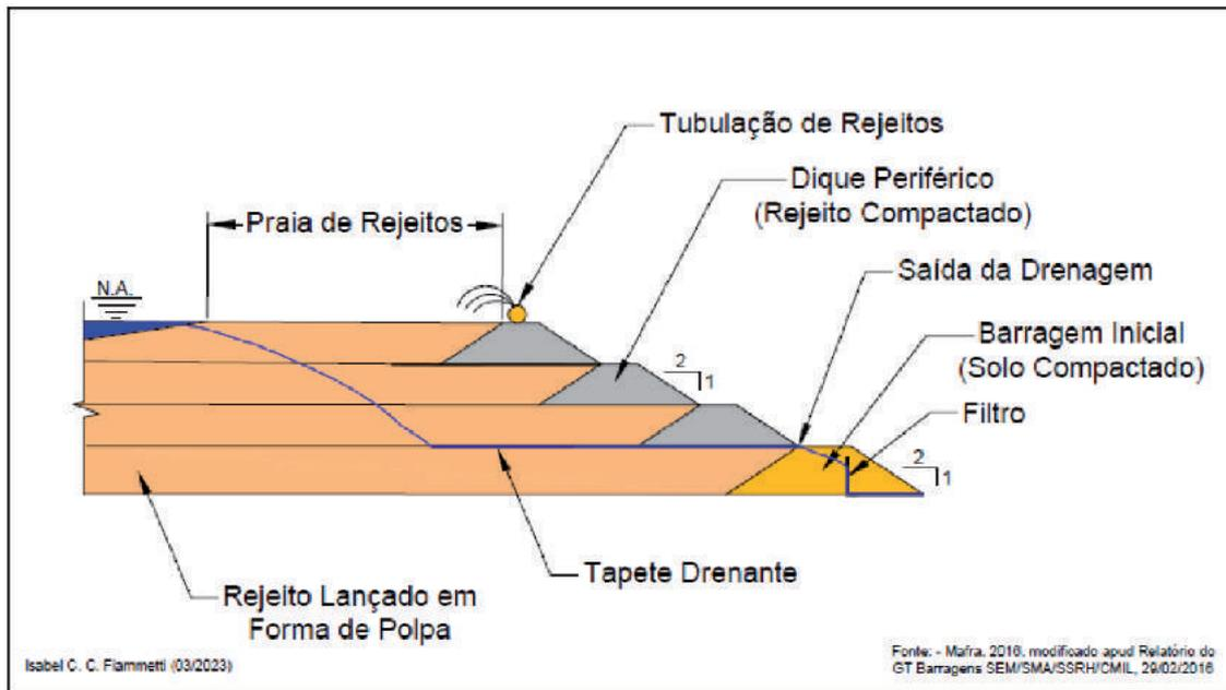
**Figura 2-** Seção esquemática de barragem de rejeitos com alteamento pelo método da Linha de Montante. Notar a indicação esquemática do maciço de fundações dos alteamentos sucessivos e um sistema de drenagem interna.
