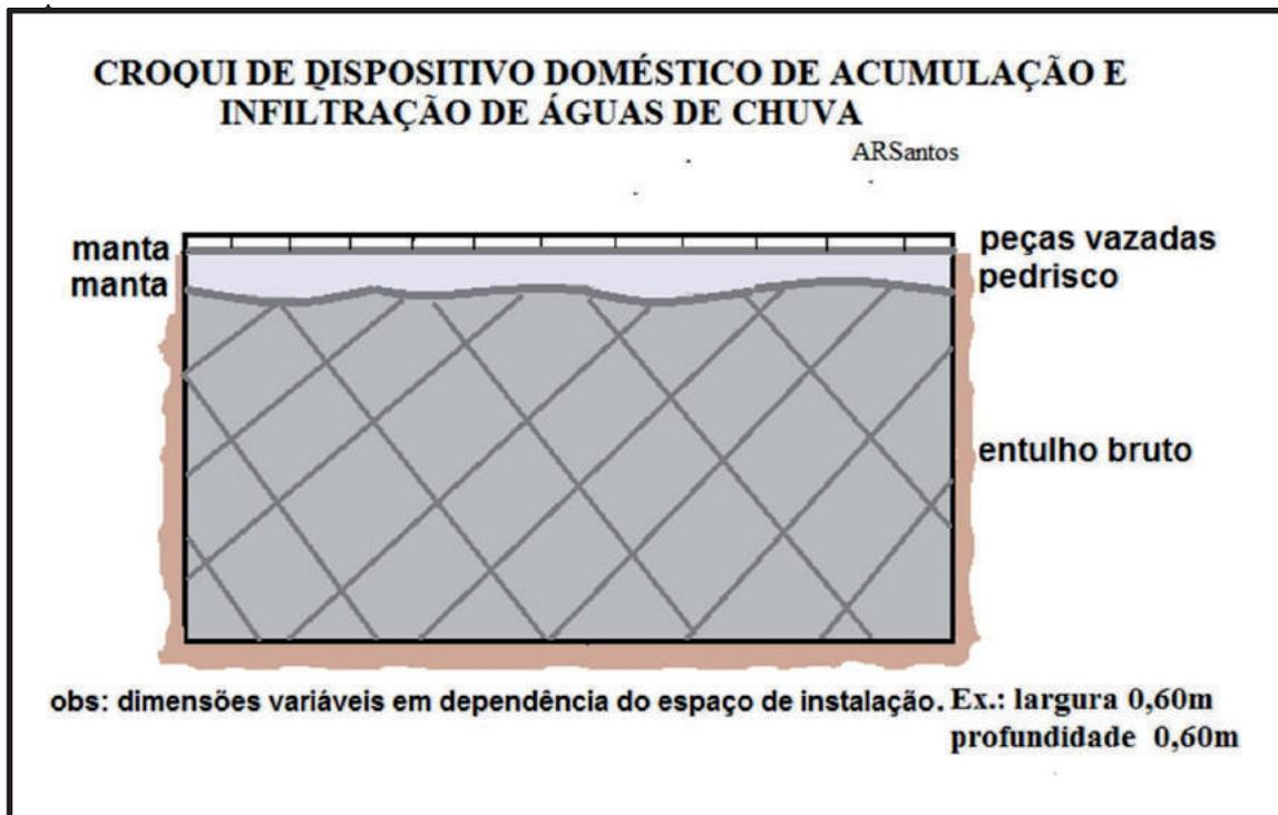
**Figura 10** - Dispositivo de acumulação/infiltração de águas de chuva, indicado para lotes de até 500m<sup>2</sup> e em especial para quintais com cobertura de pisos.
