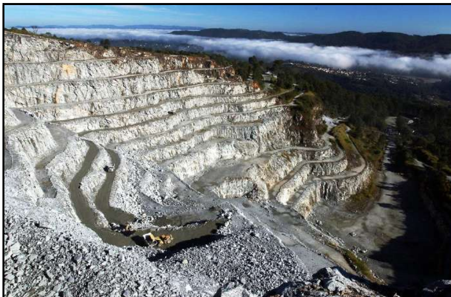
A necessidade de materiais naturais de construção (brita, areia, argila, calcário para cimento e cal) vem requerendo minerações a cada dia mais intensas e extensas, utilizando-se de tecnologias mecanizadas e automatizadas de máximo rendimento. Na foto, pedreira para produção de brita em Mairiporã ( SP). (Foto Revista Mineração&Brita)
