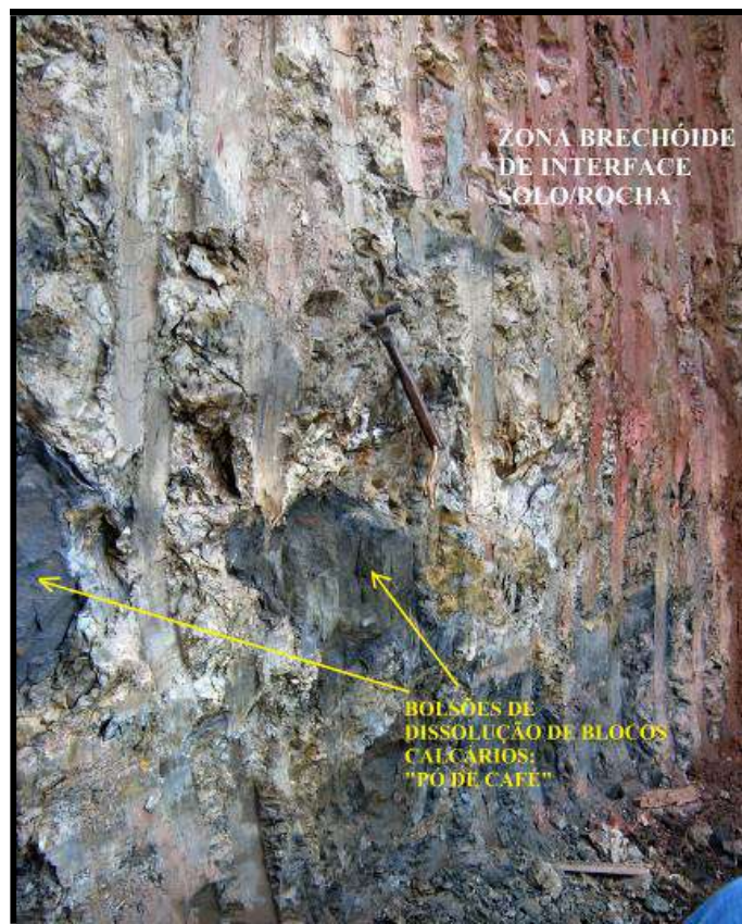
Terraplenagem que expôs porção da zona brechóide da interface solo/rocha permitindo sua investigação detalhada. Notar convivência espacial de materiais argilosos claros e avermelhados e bolsões com material pulverulento (“pó de café”) originário da dissolução de núcleos calcários. Foto ARSantos.
