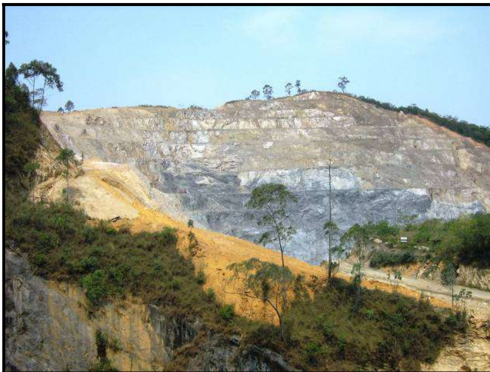
Frentes típicas de pedreiras de calcário no município de Cajamar – SP, mostrando o maciço compacto, sem a presença de figuras clássicas de dissolução. Foto ARSantos.
