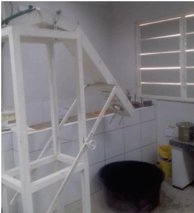
Figura 6. Vista do Equipamento de Inderbitzen (UFCA). Fonte: Os autores (2020)
