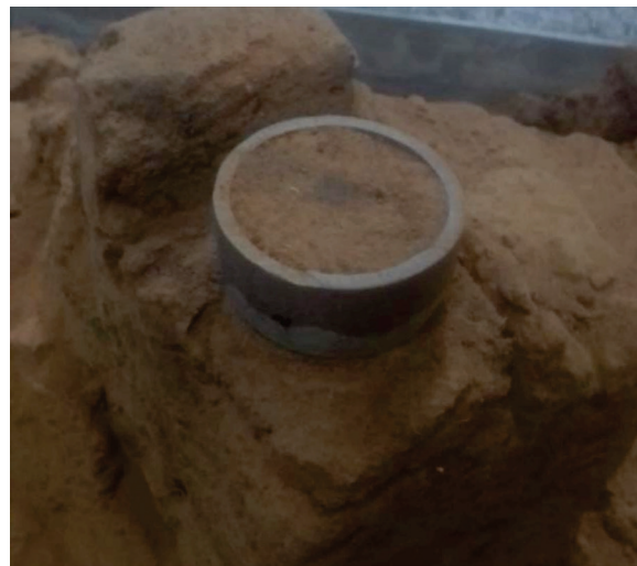
Figura 7. Moldagem do Corpo de Prova para o Ensaio de Sucção.
