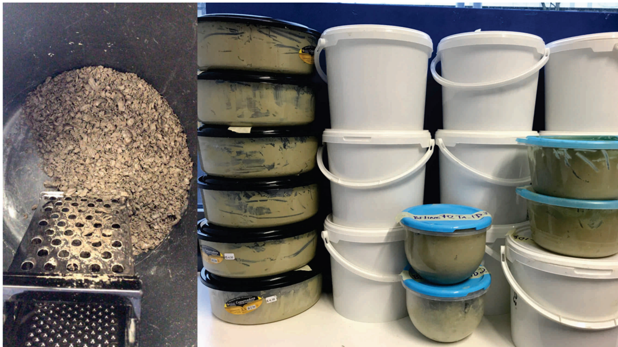
Figura 6. Preparação das amostras, à esquerda ralando rochas brandas argilosas e à esquerda, armazenando amostras em fase de obtenção da consistência. Esta é a etapa mais demorada da metodologia.
