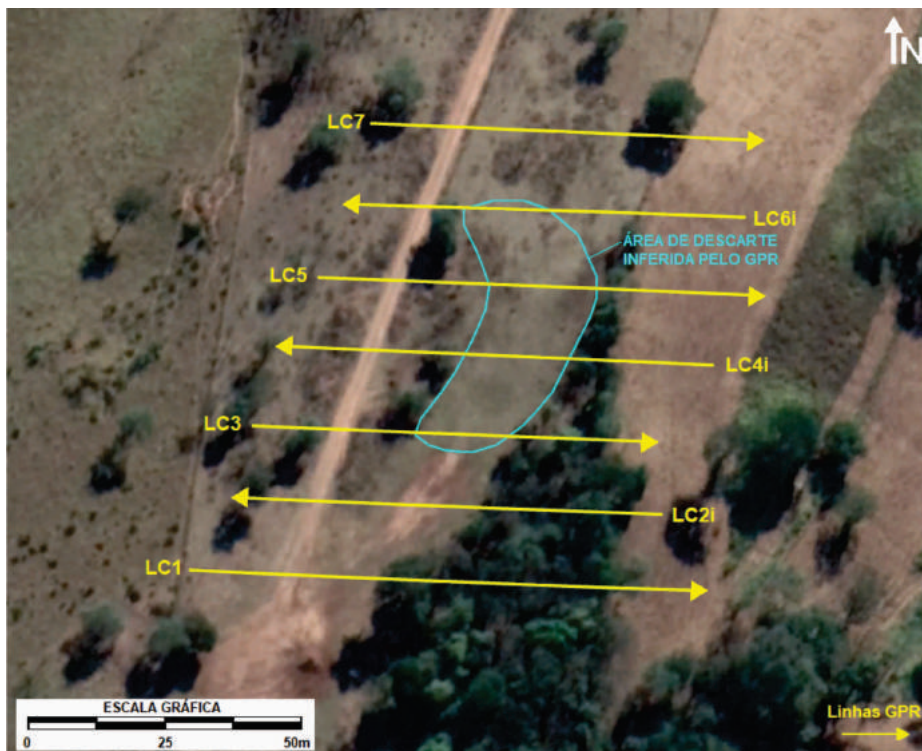
Figura 5b. Localização dos perfis GPR e área inferida com resíduos.
