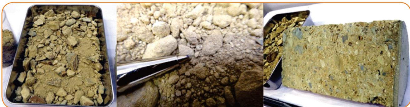
Detalhe do "agregado" utilizado na compactação do CSG, mostrando uma vista geral, um detalhe com uma esferográfica como escala e um testemunho retirado do corpo da barragem.
