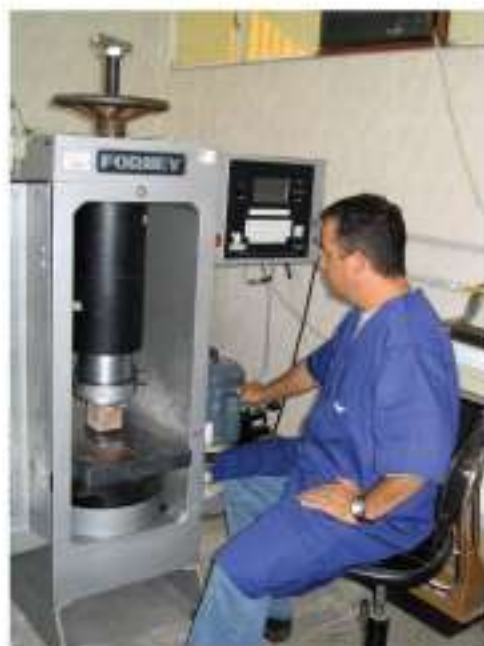
Ensaio em prensa universal no Laboratório de Rochas Ornamentais do curso de geologia, Unesp, Rio Claro (SP). Foto A. C. Arthur
