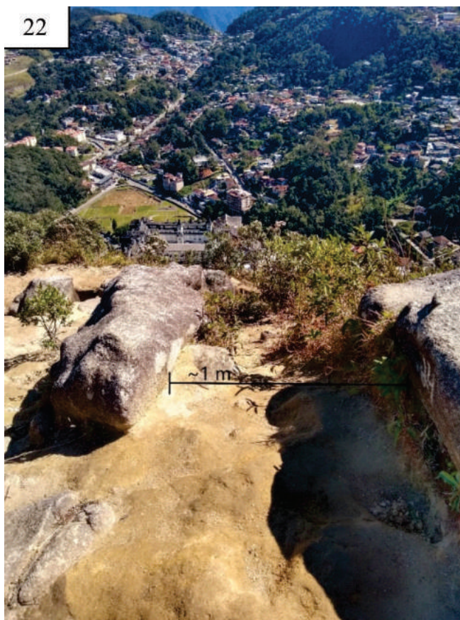
Figura 22. Fraturas tectônicas com abertura de aproximadamente 1 metro no topo da Pedra do Quitandinha. Observar também a formação de blocos pela interseção das fraturas.
