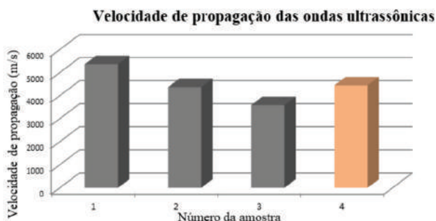
Figura 30. Gráfico do valor médio de velocidade ultrassônica, em m/s, para cada amostra analisada.
