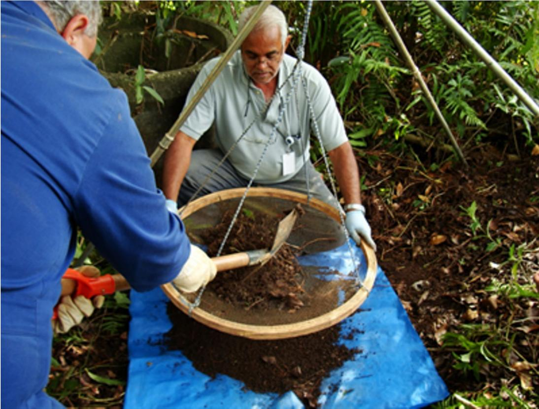
Figura 4. Peneiramento do solo em campo.
