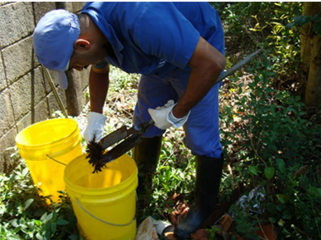
Figura 5. Descontaminação sendo executada de ponto para ponto de amostragem.
