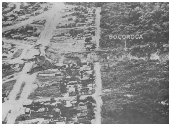
Foto 5. Vista aérea parcial de uma das boçorocas que afetaram a cidade de Cianorte, PR, sobre solos que capeiam o arenito Caiuá.
