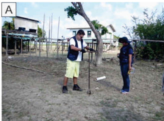
Figura 7 A e B. Obtenção da condutividade hidráulica dos sedimentos marginais da comunidade São Braz, Município de Porto de Moz – PA.
