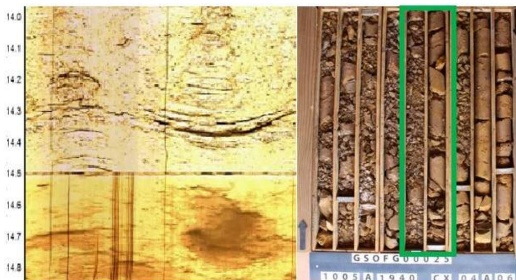
**Figura 8.** Fratura no furo GSOFG00025 (à esquerda), onde tem-se o nível d’água marcado claramente aos 14,5m e fotografia do testemunho de sondagem deste furo (à direita). A fotografia dos testemunhos não permite identificar a fratura visível no televisionamento.
