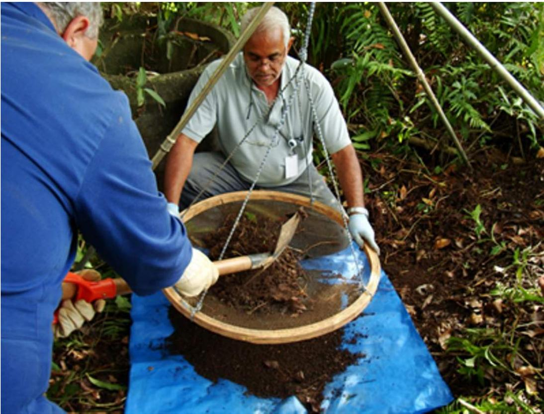
Figura 4. Peneiramento do solo em campo.
