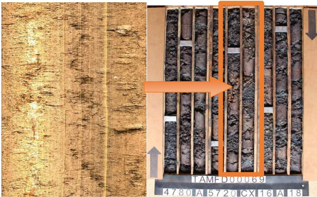
**Figura 14.** No furo FD00069, observa-se a existência de uma fratura vertical, que se estende por cerca de dois metros. Esta fratura não é vista no testemunho. A seta indica, aproximadamente, a possível localização desta fratura na caixa de testemunhos.
