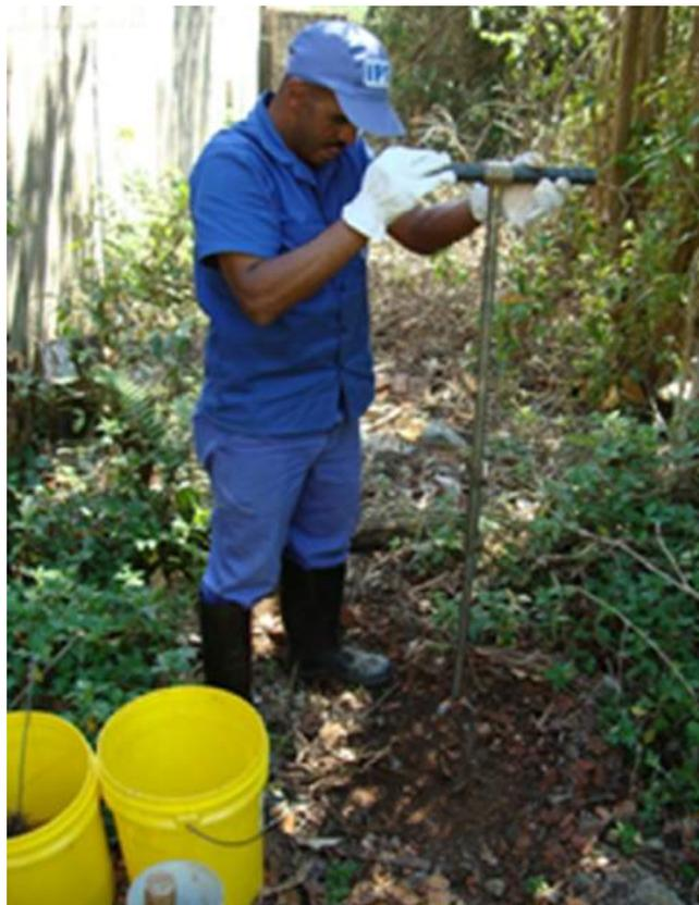
**Figura 2.** Amostra de solo superficial sendo coletada com trado manual.
