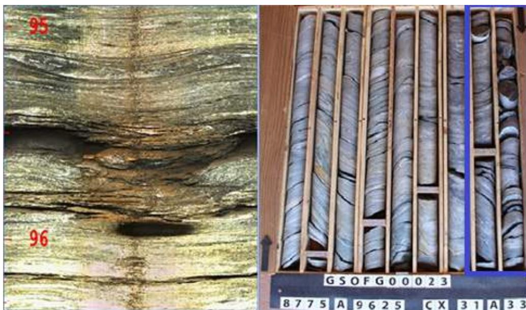
**Figura 12.** Esquerda: Imagem do furo GSO00023. Direita: Testemunho do furo GSOFG00023, sem condições de identificar-se os vazios vistos na imagem gerada pelo OTV (região entre 95m e 96m, assinalada em azul na caixa de testemunhos).
