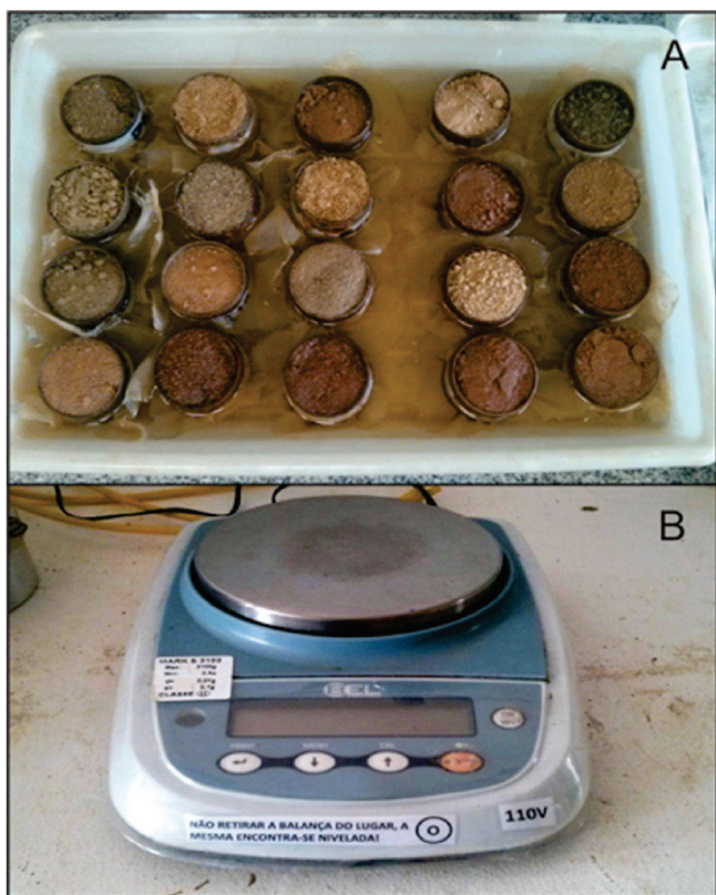
Figura 6. A: Amostras em processo de saturação por capilaridade; B: Balança de precisão.
