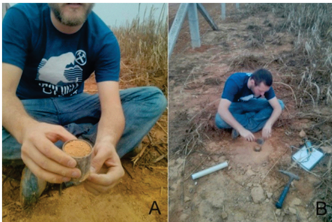
Figura 5. A: Cilindro fora do solo; B: Coletando amostra do solo e materiais utilizados.
