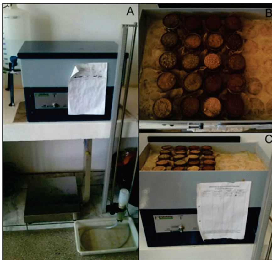
Figura 7. A: Mesa de tensão fechada; B: Amostras dentro da mesa de tensão; C: Mesa de tensão aberta com amostras.
