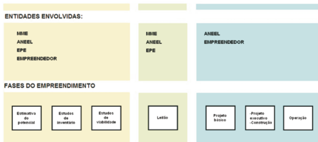
Figura 4 - Etapas de implantação de aproveitamentos hidroelétricos. Fonte: Modificado de Eletrobras (2007).
