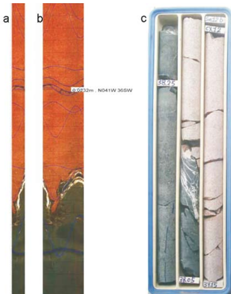
Figura 9 - Comparação entre testemunho virtual (a); imagem das paredes desdobrada em 360° (b) e testemunho convencional (c) Fonte: Fundsolo - Mesa Redonda ABGE/ABMS (2011).
