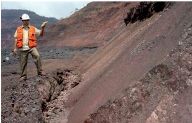
**Figura 12** – Detalhe da superfície de ruptura na máfica decomposta (contato de lapa).
