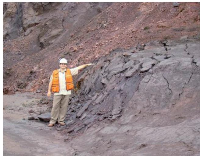
**Figura 16** – Fase final do soerguimento no pé da ruptura da ordem de 2,5 m
