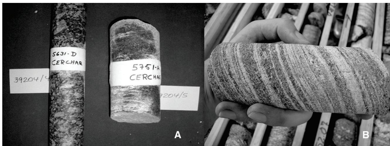
**Figura 1** – Amostras do Complexo Embu. Granitos (A) e Gnaisses (B). Fonte: Metrô-SP.
