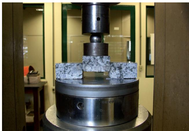
**Figura 6** - Corpo de prova montado sobre a prensa
