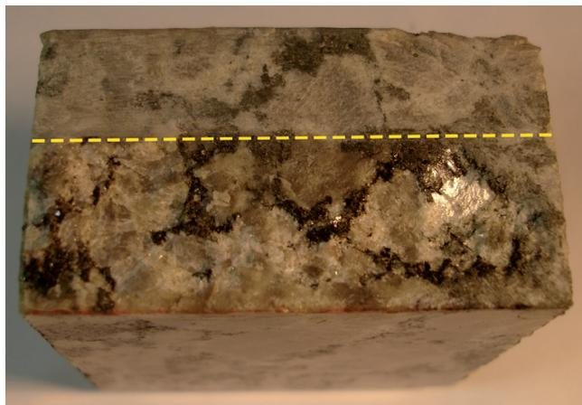
**Figura 10** – Descolamento do corpo de prova na rocha. A linha pontilhada demarca a área colada.
