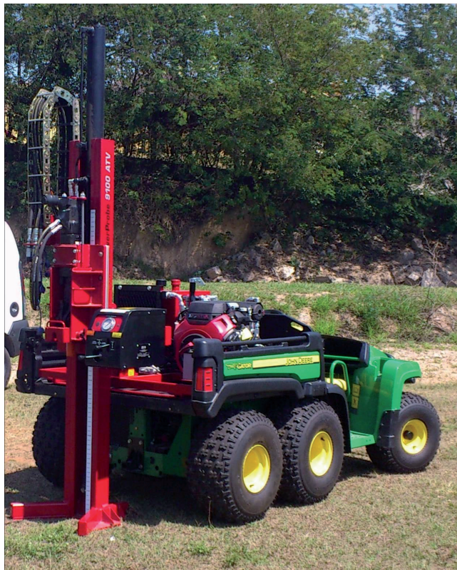
Figura 3 – Sonda preparada para realização do ensaio RCPTu e tela do computador com o resultado do ensaio em tempo real no campo a medida que o mesmo vinha sendo realizado
