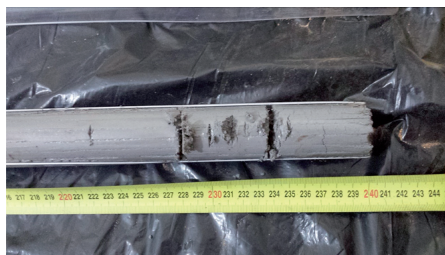
Figura 10. Seleção da amostra discreta a ser enviada ao laboratório após aplicação do UV-A.
