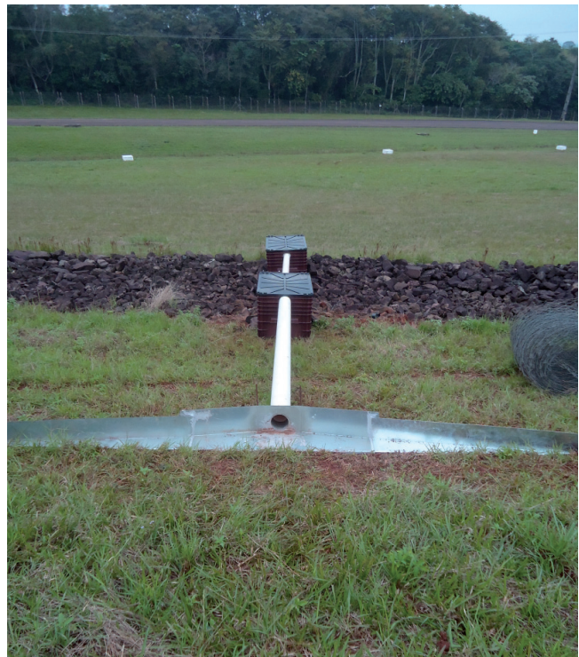
Figura 5. Sistema coletor: vista geral do sistema, à frente as calhas coletoras, ligadas à primeira caixa por tubo de PVC.
