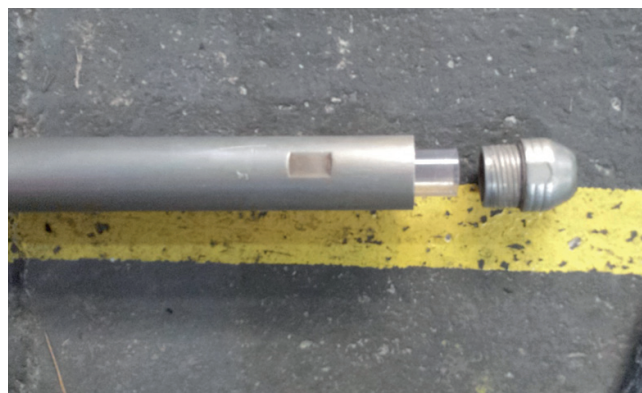
Figura 3. Parte inferior do Amostrador Tubular Liner revestido pelo tubo externo do Dual Tube .
