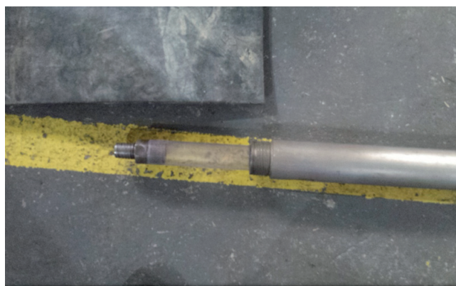
Figura 2. Parte superior do Amostrador Tubular Liner revestido pelo tubo externo do Dual Tube .
