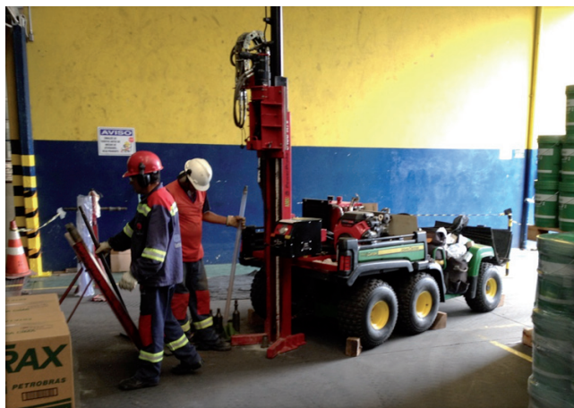
Figura 1. Sonda AMS Power Probe 9100 ATV efetuando operação Dual Tube Sampling .
