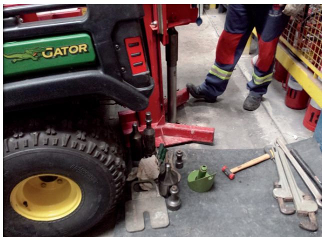
Figura 5. Cravação do equipamento Dual Tube para coletar amostras de solo.
