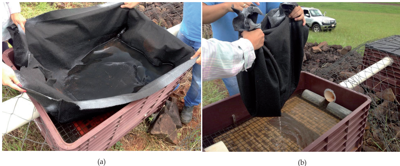
Figura 8. Sequência de retirada da geomanta contendo os sedimentos gerados.
