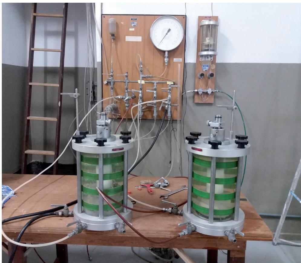
Figura 1. Corpo de prova do ensaio no permeômetro de parede flexível.
