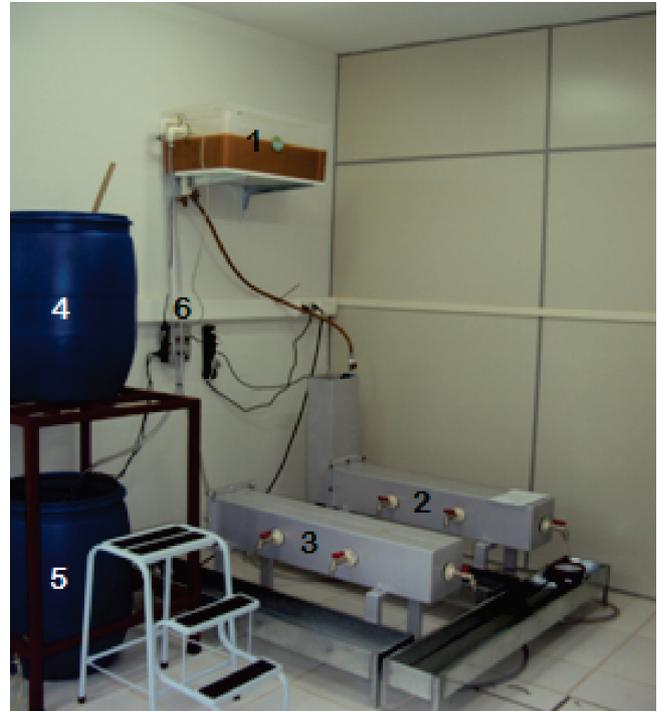
**Figura 2** - Componentes do sistema de permeâmetros para percolação de água + sedimentos. Detalhes no texto.
