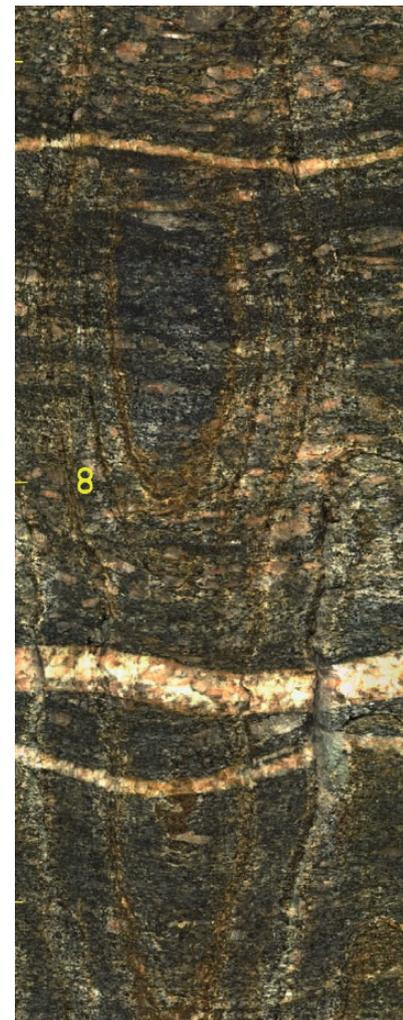
Figura 22 – Exemplo de ocorrência de *set* de fraturas verticais, com relação à direção do furo televisado. Fonte: Metrô de SP.
