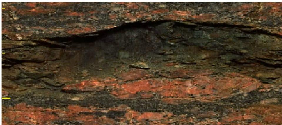
**Figuras 15 e 16** - Planos de fraturas abertas, na primeira figura associado a um sistema de fraturas paralelas e na segunda figura observar trecho de rocha muito alterada e comiúda, provavelmente relacionada a um plano de falha, que foi lavado na perfuração de sondagem. Fonte: Metrô-SP.
