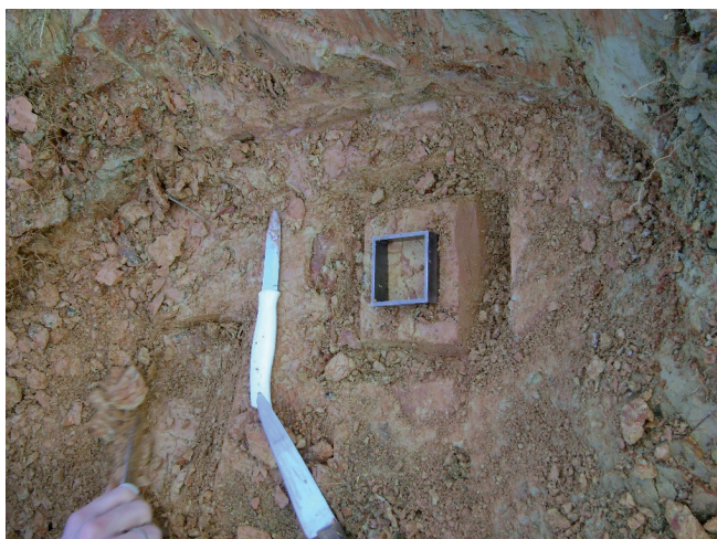
Figura 6. Processo de moldagem, em campo, de corpo de prova a ser ensaiado. O molde metálico mede duas polegadas de lado e dois centímetros de altura.
