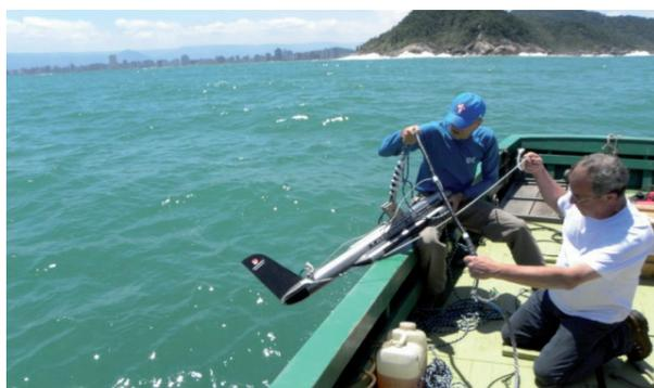
**Figura 6** – Sonar de Varredura Lateral Klein em operação na Praia Grande, litoral de São Paulo, Brasil; a) foto a esquerda, a fonte acústica de dupla frequência (100/500 kHz) denominada de “peixe”; b) foto a direita, equipe do IPT em operação de lançamento do peixe.
