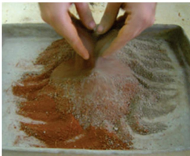
**Figura 2** - Mistura manual dos solos. Nesta foto mistura de 50%LPA : 50%GLE.
