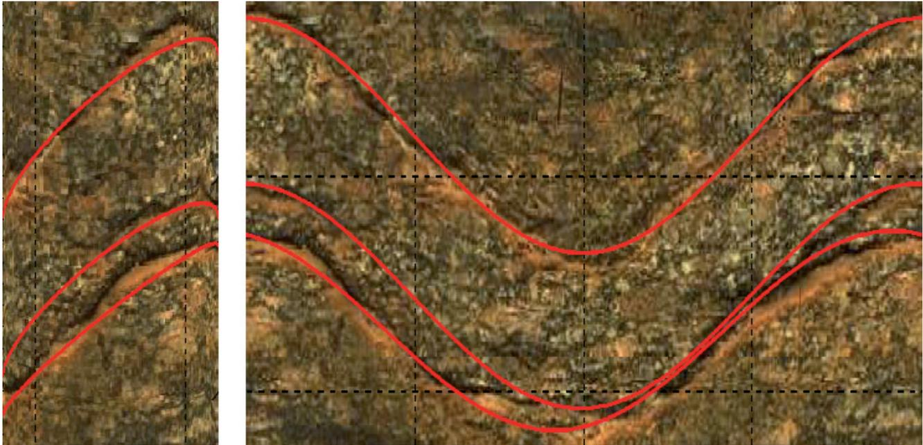
**Figura 6** – Exemplo de fratura delimitada digitalmente, com uma linha vermelha (imagem “enrolada” à esquerda e “desenrolada” à direita), após análise utilizando software de televisamento RGLDIP da câmera OPTV, da *Robertson Geologing*. E exemplo de descontinuidade rugosa, citado no item *RUGOSIDADE*. Fonte: Metrô-SP.
