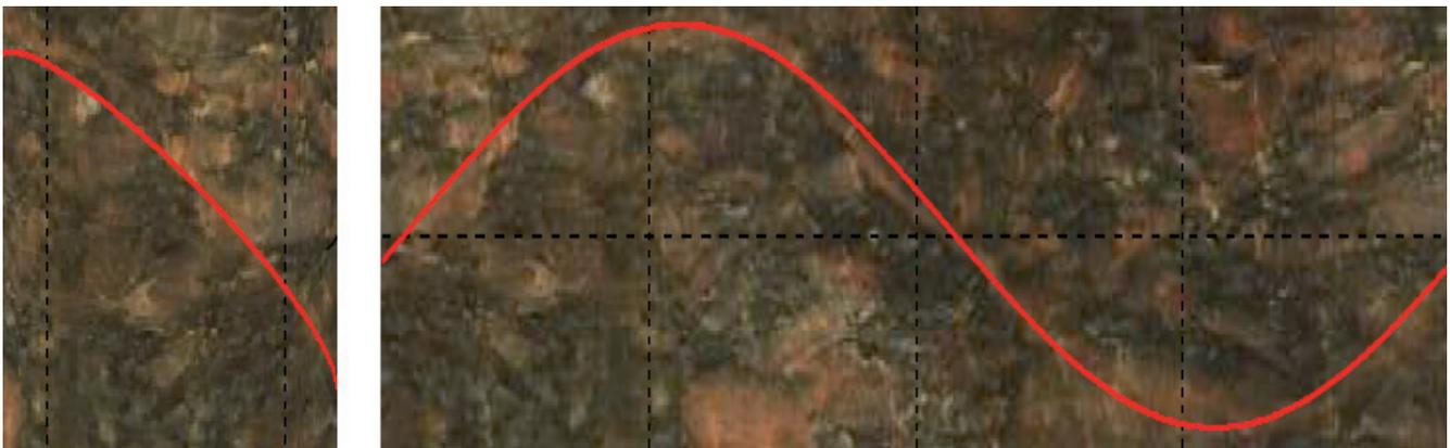
Figura 11 – Exemplo de plano de fratura lisa. Notar que é quase imperceptível a visualização da fratura devido ao “encaixe” quase perfeito com a linha de referência em vermelho. Fonte: Metrô-SP.
