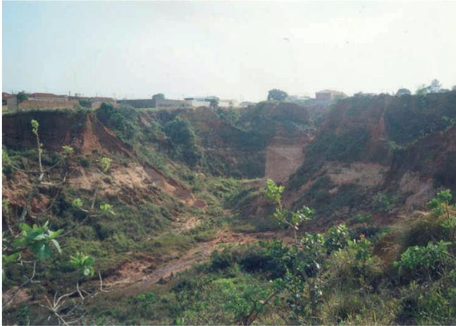
**Foto 3** - Vista geral de jusante para montante da boçoroca. Ao fundo da erosão, na linha do talvegue, observam-se diversos pontos de surgências d'água. Notam-se abatimentos e escorregamentos nas vertentes da feição erosiva.
