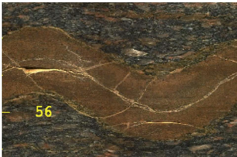
**Figura 7** - Veio de 20 cm de espessura com fraturas que não se propagam para a rocha adjacente, evidência de comportamento geomecânico distinto entre os materiais. Fonte: Metrô-SP.
