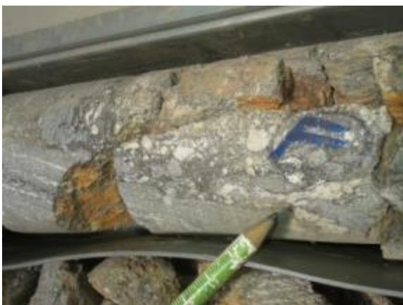
Foto 39 - Testemunho das sondagem 4534 indicando rocha com feições cataclasadas 4515 (Metrô-SP).
