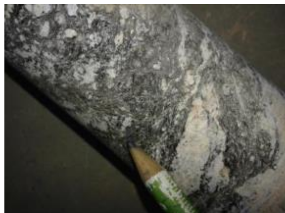
Foto 40 - Testemunho da sondagem inclinada 4539, indicando rocha com feições cataclasadas 4515 (Metrô-SP).
