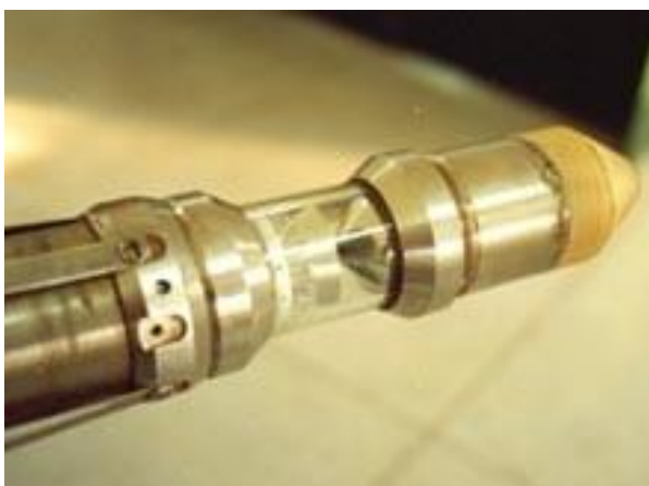
Foto 1- Foto do equipamento da Robertson Geologging, detalhe do sistema de captação e cone de proteção (Baillot et al. , 2004).
