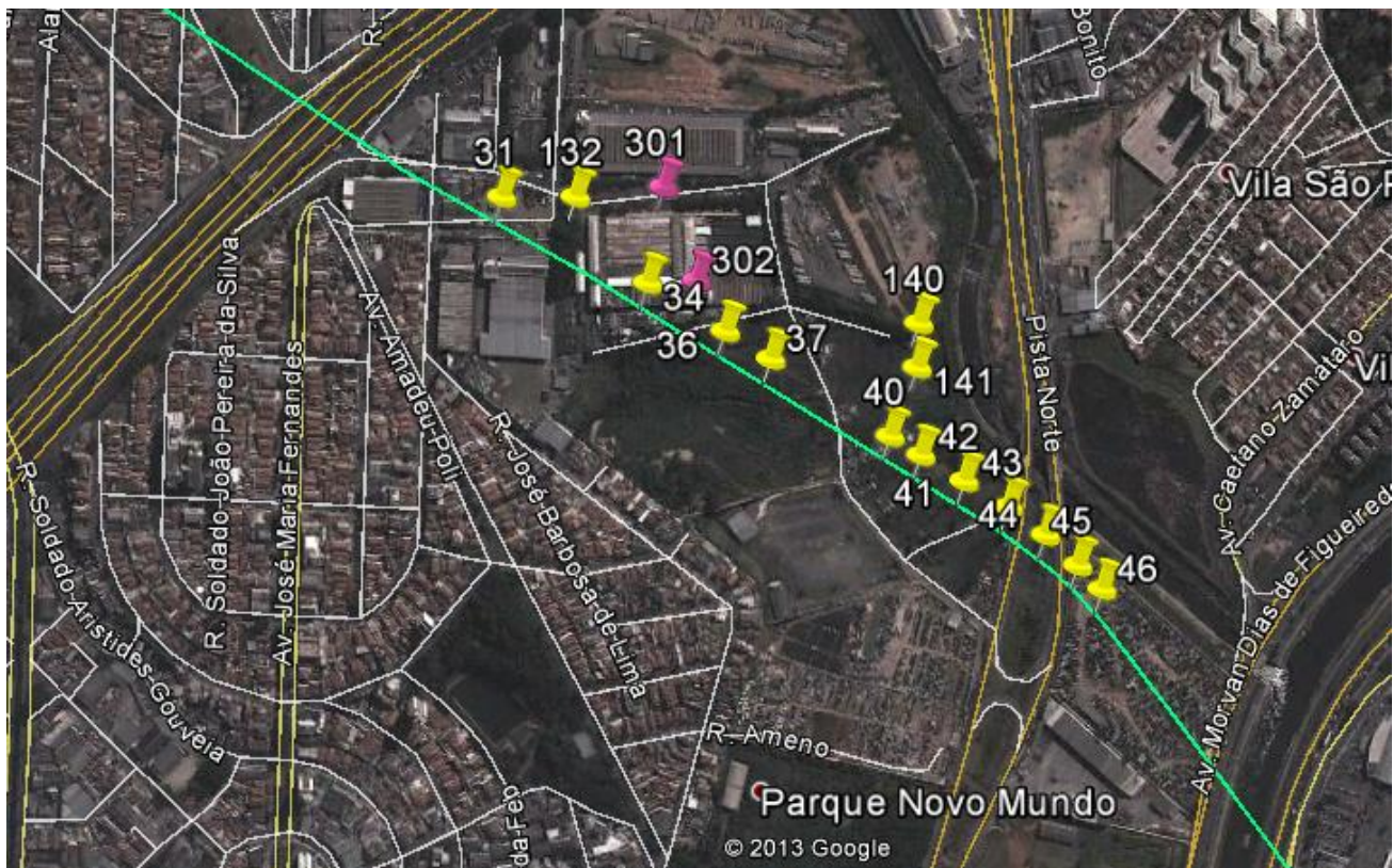
Figura 47 – Furos de sondagem analisados no trecho não adotado da extensão da Linha 2 Verde, Metrô-SP (imagem do Google Earth).
