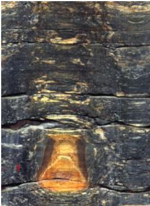
Foto 43 – Fraturas abertas na sondagem 4544 (Metrô-SP).
