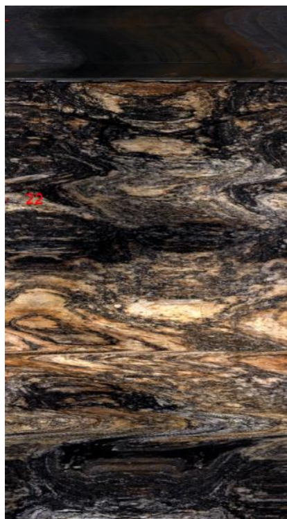
Foto 5 - Exemplo de interferência na imagem devido ao revestimento metálico no furo de sondagem. Fonte: Metrô de São Paulo.
