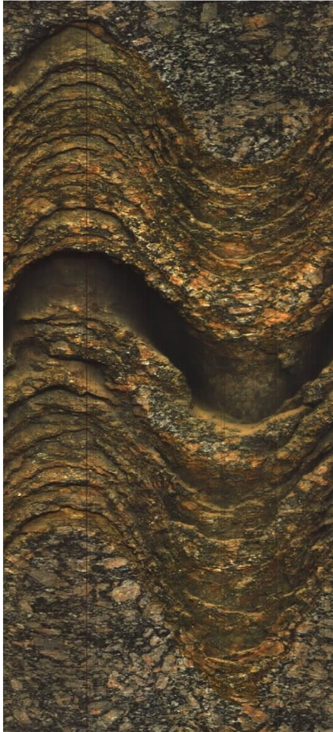
Foto 32 – Sistema de fraturas paralelas, pouco espaçadas, aumentando o grau de fraturamento no trecho de um maciço pouco fraturado. Fonte: Metrô-SP.
