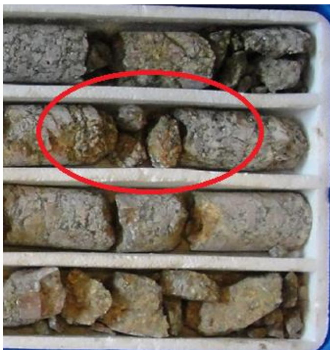
Foto 19 – Foto do testemunho de sondagem referente à falha da Foto 18, onde não foi possível observar a presença da estrutura, devido à quebra do testemunho rochoso. Fonte: Metrô-SP.
