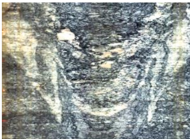
Foto 36 - Televisonamento da sondagem 4559 (presença de veios dobrados) (Metrô-SP).
