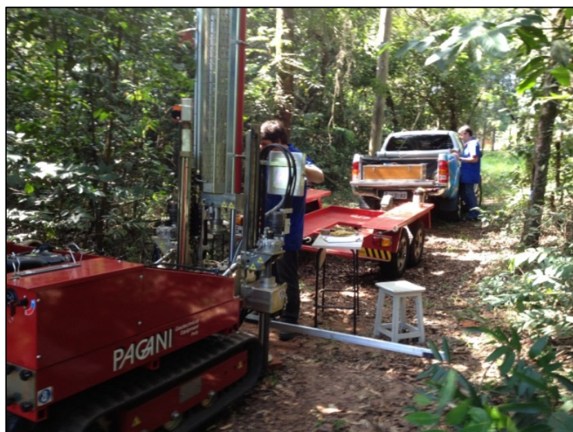
Figura 46. Equipamento de cravação Pagani durante realização dos ensaios CPT e CLT.
