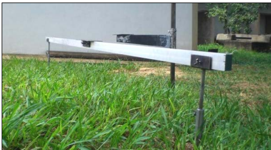
Figura 41. Viga de referência instalada
