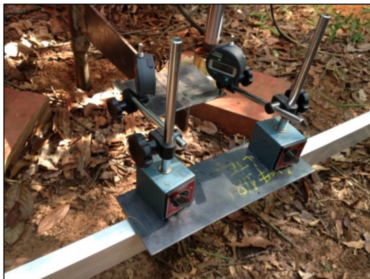
Figura 48. Montagem dos relógios comparadores na viga de referencia.
