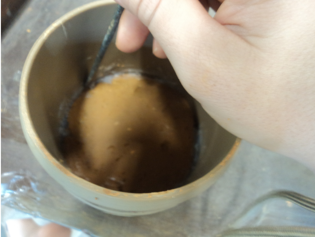
Figura 6.12 – Selamento do caminho preferencial entre a amostra indeformada e a parede do cilindro.
