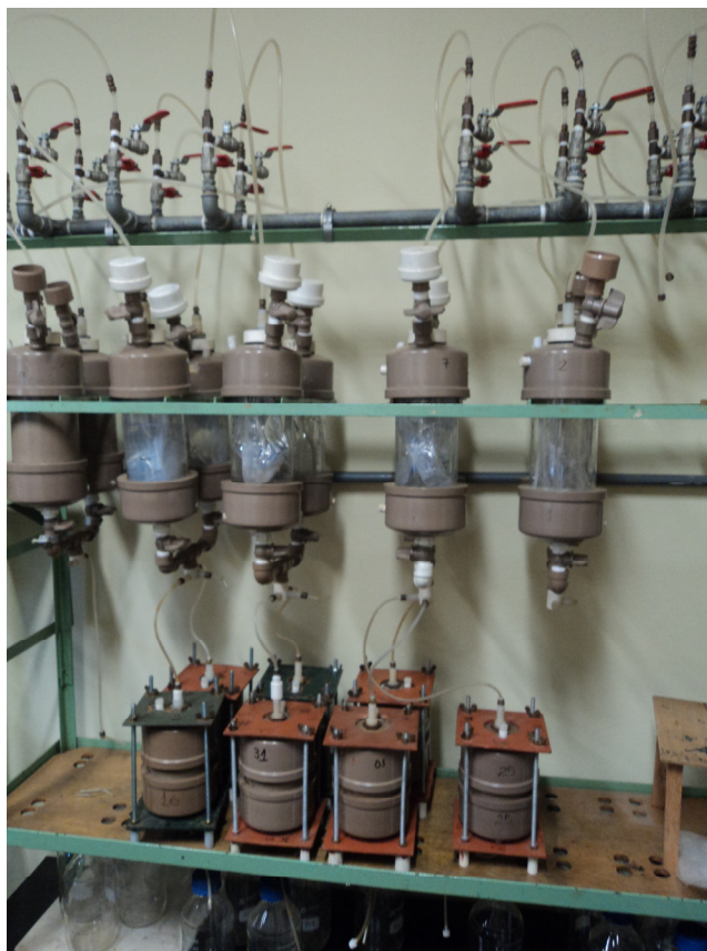
Figura 6.16 – Ensaio de permeabilidade.
