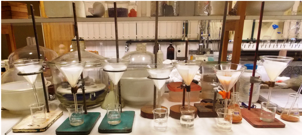
Figura 6.21 – Filtragem do extrato de solo com solução PbCl_2 .
