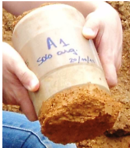
Figura 6.3 – Coleta da amostra indeformada (coluna de PVC).
