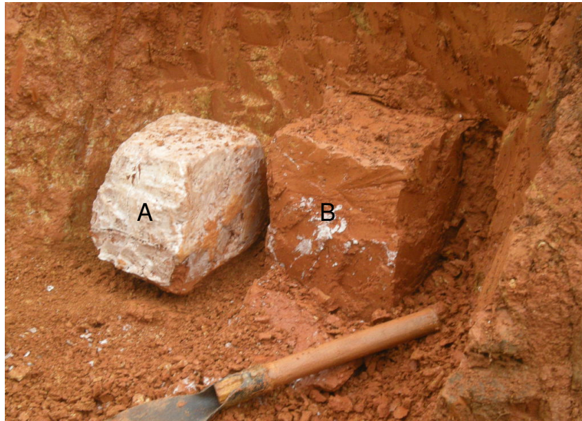
Figura 6.4 – Coleta da amostra indeformada (bloco). A) Bloco com parafina. B) Bloco sem parafina
