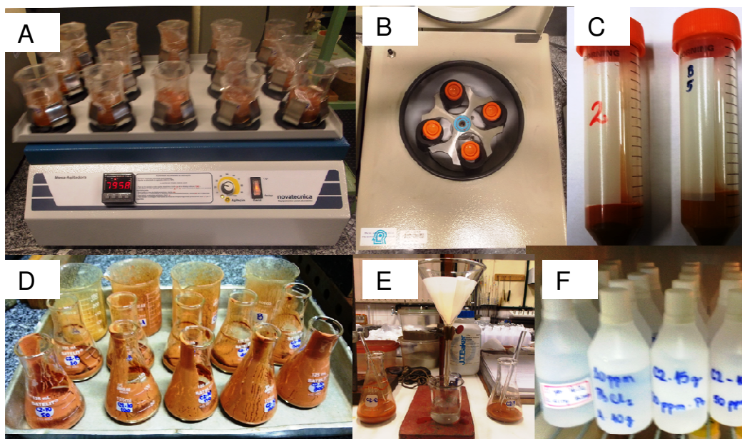
Figura 6.22 – Execução dos ensaios de equilíbrio em lote. A) Agitação dos extratos de solo e solução de cloreto de chumbo II; B) Extratos na centrífuga para segregação do solo e solução; C) Solo segregado da solução após centrifugação; D) Erlenmeyers após separação da solução; E) Filtragem da solução; F) Amostras das soluções armazenadas no refrigerador.
