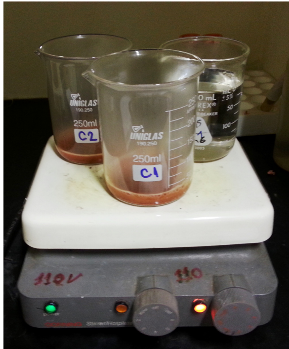
Figura 6.6 – Ensaio de determinação do teor de matéria orgânica em execução.
