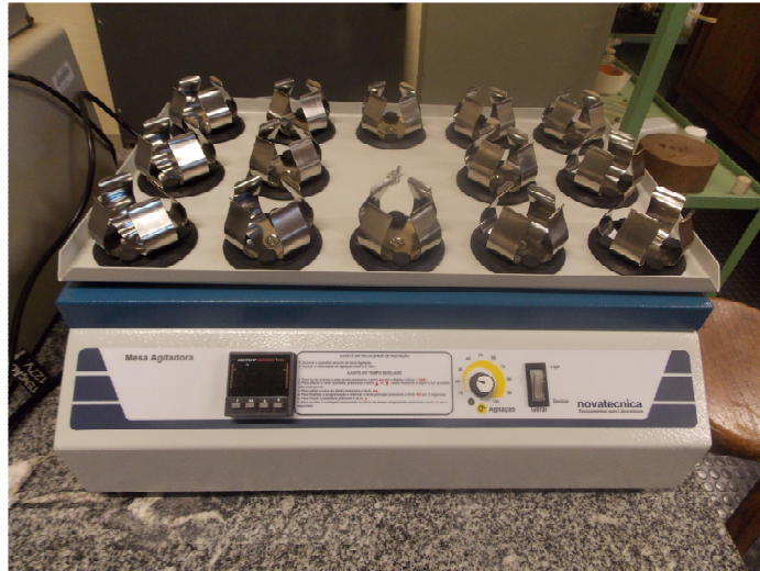
Figura 6.19 – Mesa agitadora empregada no ensaio de equilíbrio em lote para agitação dos extratos solo/solução.
