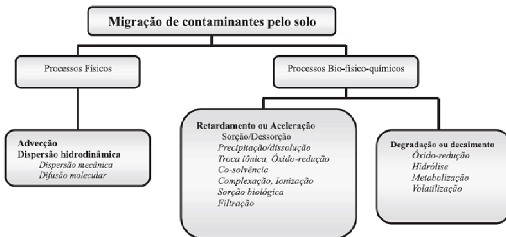
Figura 5.3 – Mecanismos de migração de contaminantes pelo solo. Fonte: Moncada (2004 apud MELO et al., 2004).
