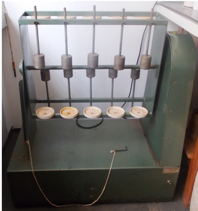
Figura 6.7 – Dispersor rotativo empregado na suspensão das amostras (solo/solução) para obtenção do pH ( H_2O e KCl).
