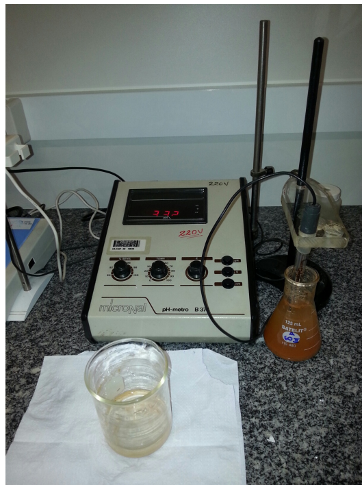
Figura 6.22– pHmetro Micronal B376 com eletrodo de anel de platina empregado na determinação do Eh
