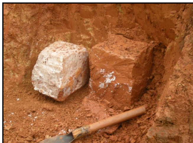
FIGURA 13: Coleta de solo indeformado (bloco coletado com caixa metálica 30 x 30 cm), ponto de amostragem SA. O bloco da esquerda recebeu camada de parafina. Silva, B. C. M.; Sígolo, J. B.; Rodrigues, V. G. S.
