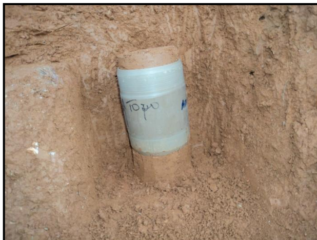
FIGURA 12: Coleta a partir do emprego de tubo PVC (de 4”), ponto de amostragem SC. Rodriguez, J. R.; Sígolo, J. B.; Rodrigues, V. G. S.
