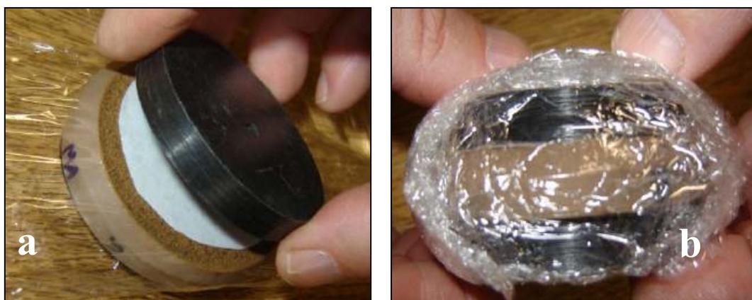
Figura 4.16- a: Papel filtro em contato com o solo; b: Armazenamento dos anéis (FERNANDES, 2011)
