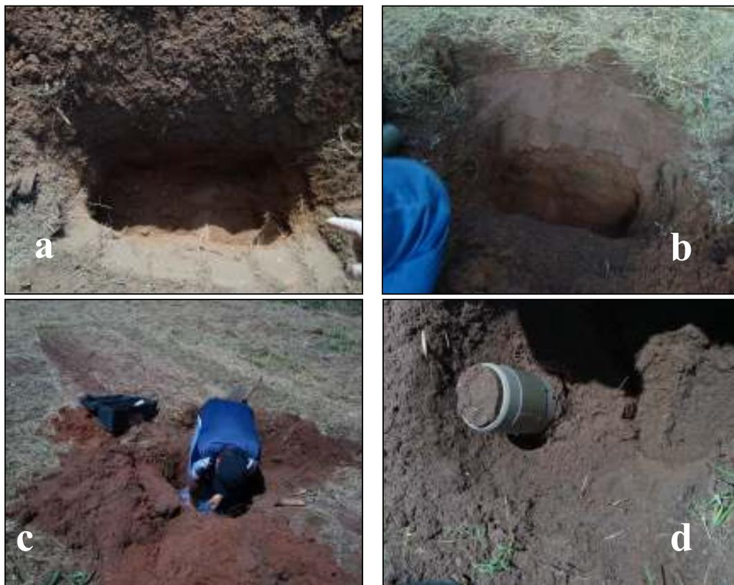
Figura 4.5- a e b: Cava para coleta das amostras; c: Coleta de amostras deformadas; d:Indeformadas
