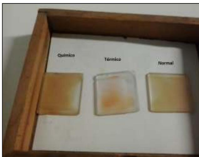
Figura 4.7- Lâminas para o ensaio de DRX
