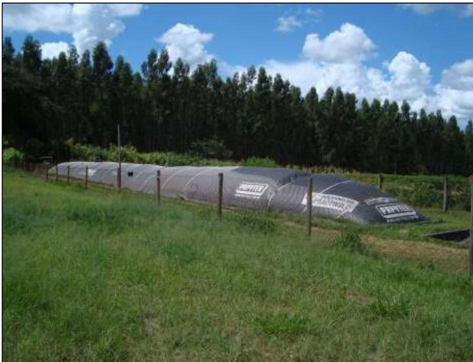
Figura 4.4- Biodigestor anaeróbio modelo canadense
