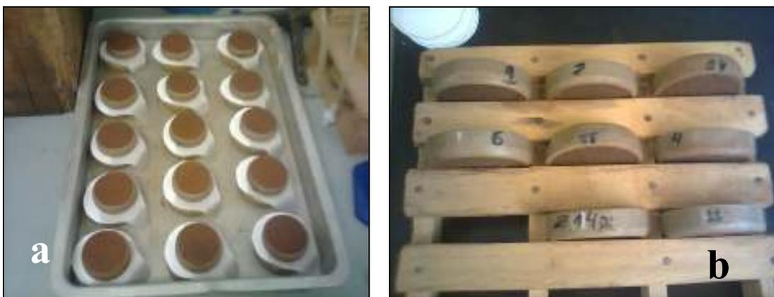
Figura 4.15- a: Saturação dos anéis; b: Secagem dos anéis
