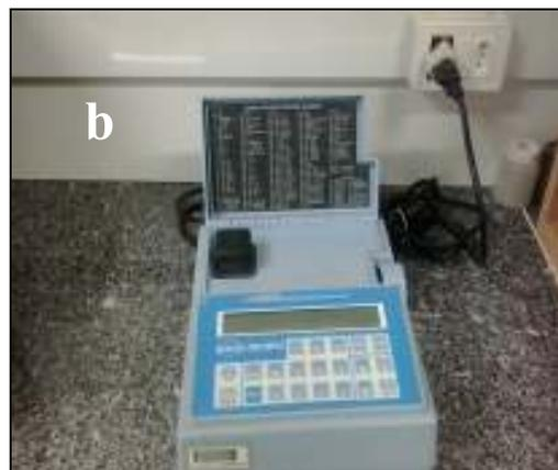
Figura 4.21- Equipamentos utilizados para medições físico-químicas. a: fotômetro de chama; b: espectrofotômetro
