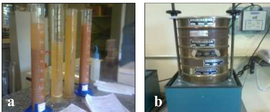
Figura 4.8- a: Ensaio de granulometria: sedimentação; b: Ensaio de granulometria: peneiramento
