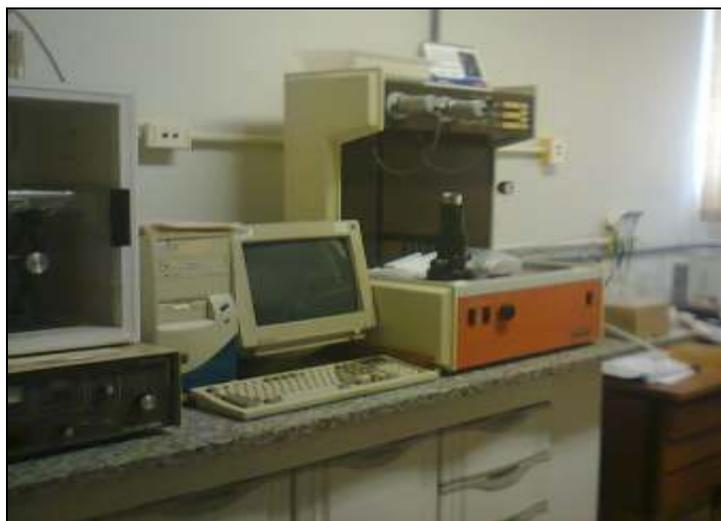
Figura 4.13- Equipamento para realização da porosimetria por intrusão de mercúrio
