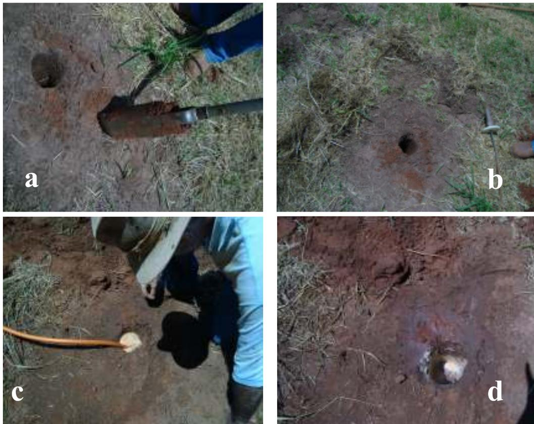
Figura 4.6- a e b: Abertura do furo; c: Injeção de água; d: Rebaixamento da água
