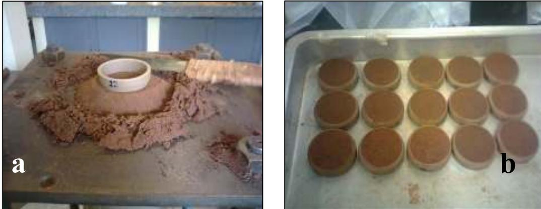
Figura 4.14- a: Moldagem dos anéis; b: Anéis moldados
