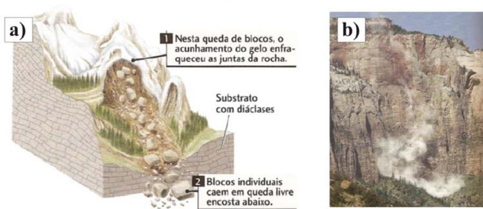
**Figura 3.4.** a) Esquema ilustrando queda de blocos. b) Foto ilustrando o processo. Fonte: Press et al. (2006).
