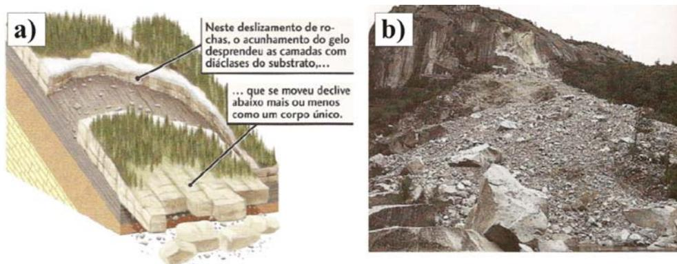
**Figura 3.3.** a) Esquema ilustrando um escorregamento ou deslizamento de blocos de rocha. b) Foto ilustrando o processo. Fonte: Press et al. (2006).
