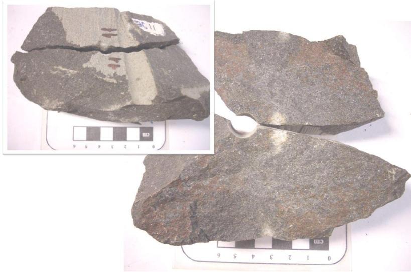
**Figura 4.34** – Amostra após ensaio de carga pontual, com oxidação interna acentuada na face de ruptura (condição de pré-ruptura).
