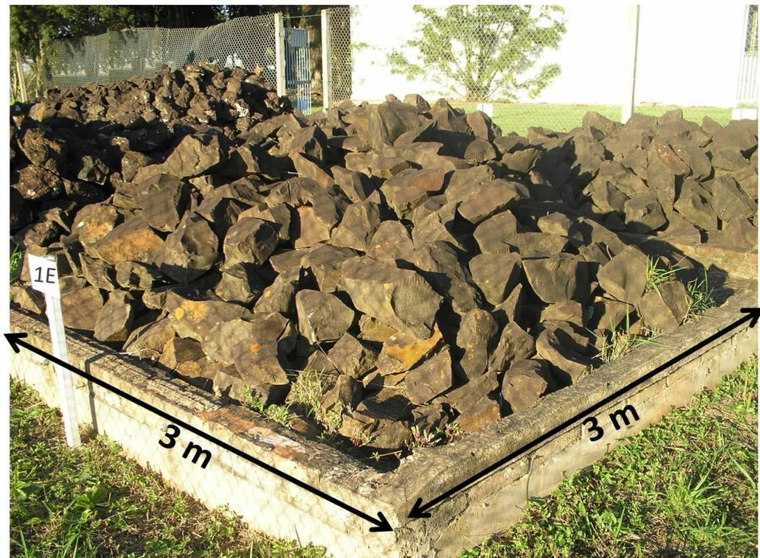
**Figura 3.3** – Ensaio de Ciclagem Natural em Grande Escala de Itaipu, pilha de rocha 1E.
