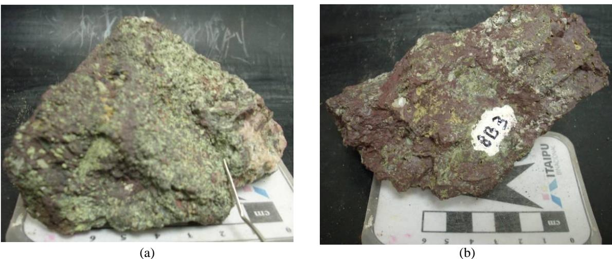
**Figura 4.14** – Blocos do tipo 8B<sub>E</sub>, (a) imagem mesoscópica de bloco com predomínio de argilomineral e (b) de bloco com predomínio de argilito/siltito.
