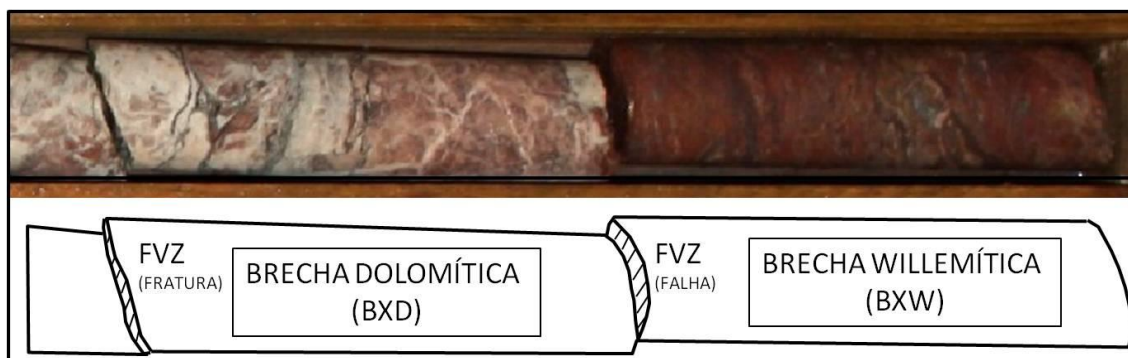
Figura 6-8: Imagem do testemunho de sondagem do contato entre brecha dolomítica e brecha willemítica da Mina de Vazante, e o desenho dos traços da Falha Vazante (FVZ).
