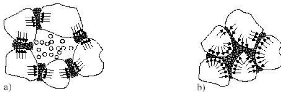
Figura 3.2 Estrutura do solo colapsível: a) antes da inundação; b) depois da inundação (JENNINGS & KNIGHT, 1957)
