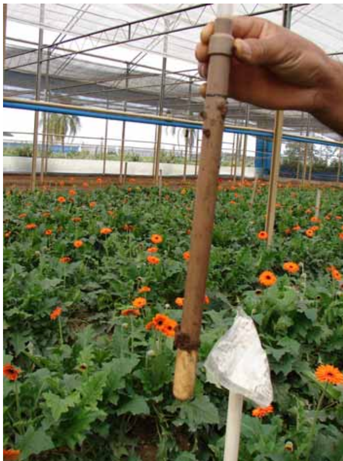
Figura 8 – Extrator de água, com cápsula porosa na base, utilizado na estufa em Holambra.
