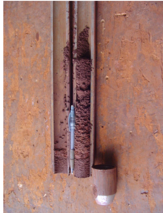
(b) Penetração do amostrador com a ocorrência do embuchamento (Argila areno-siltosa) – Pátio da Sondobase/Ribeirão Preto (SP)
