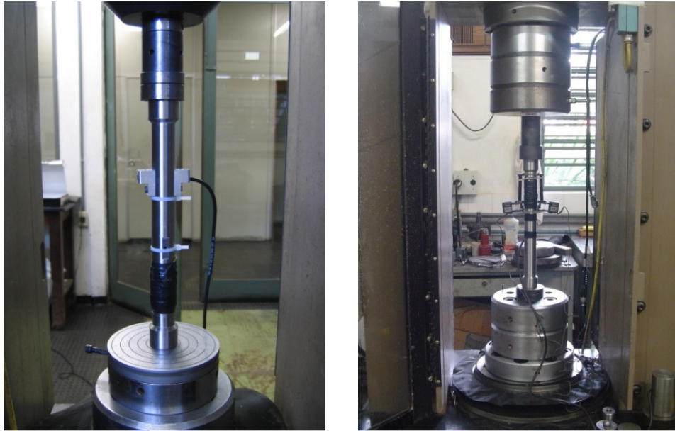
Figura 4.28 – Calibração estática da célula de carga.
