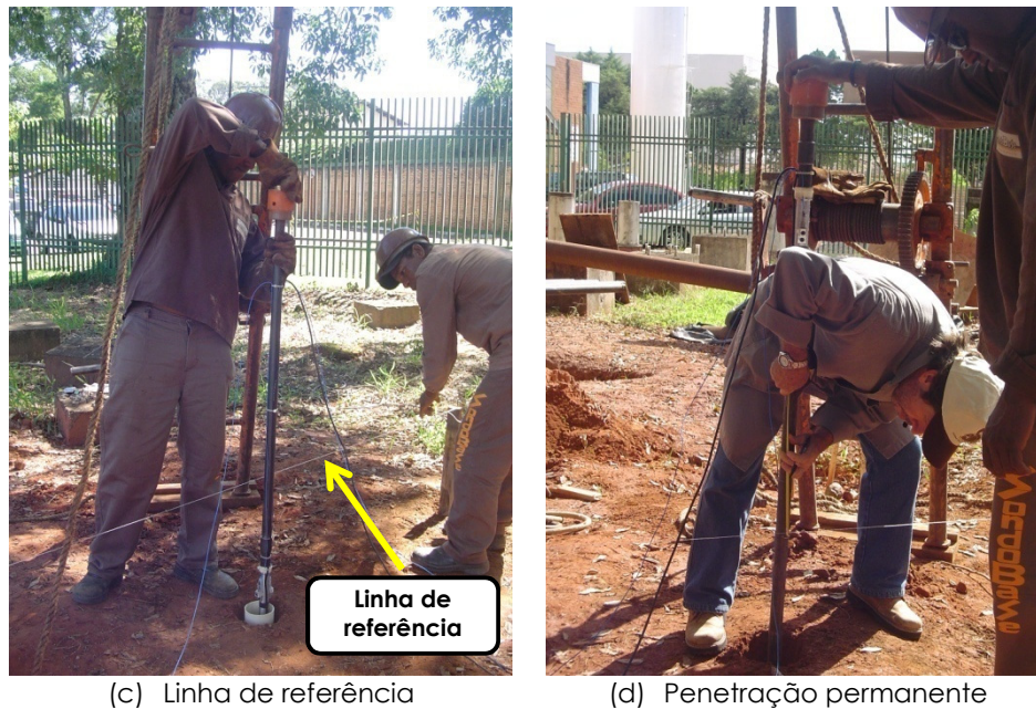
Figura 5.15 – (a) linha de referência utilizada para medida da penetração permanente (b) medida da penetração permanente
