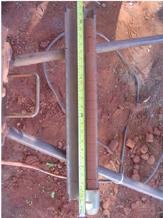
(a) Penetração do amostrador sem a ocorrência do embuchamento (Areia média pouco argilosa) Campo Experimental da UNESP de Bauru.
