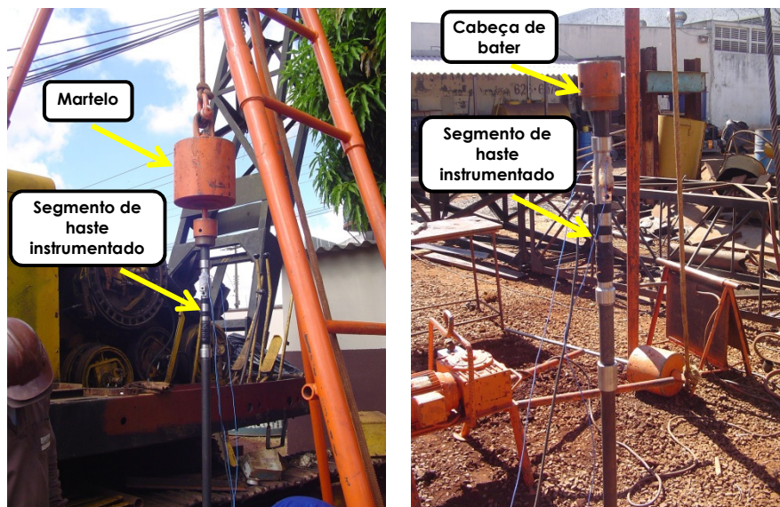
Figura 5.10 – Segmento de haste instrumentado posicionado abaixo da cabeça de bater
