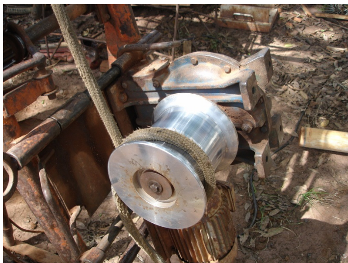
(a) Sistema de levantamento do martelo
