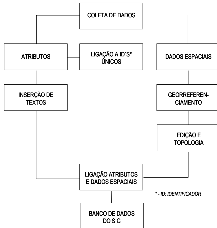
Figura 3.3 Projeto genérico de um banco de dados em ambiente de SIG (Teixeira & Christofoletti, 1997).
