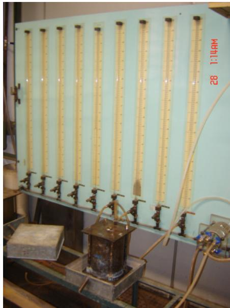
Figura 3.9 – Permeômetro conectado no painel de permeabilidade.
