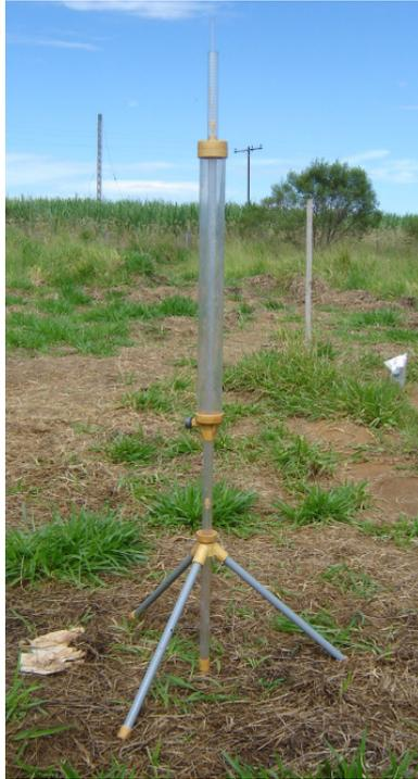
Figura 3.16 – Execução de ensaio com o permeâmetro Guelph.
