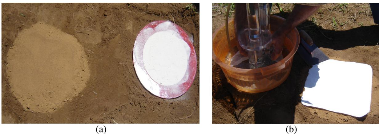
Figura 3.13 – Pré funcionamento do equipamento (a) preparação da superfície do pré-funcionamento e (b) colocação do papel filtro comum.
