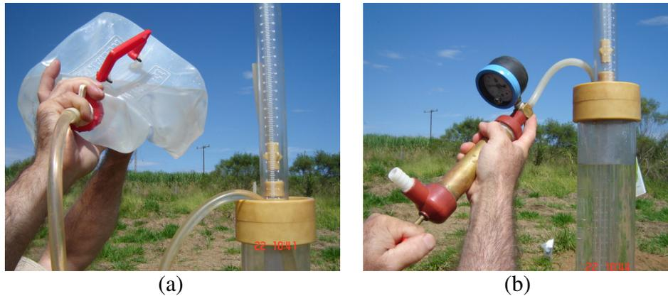
Figura 3.15 – Permeâmetro Guelph (a) preenchimento dos reservatórios com água e (b) detalhe da bomba de vácuo.
